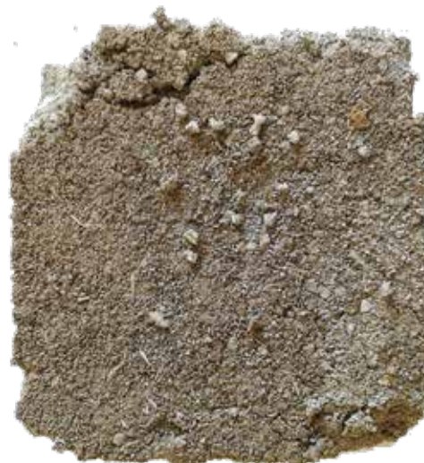
Fig. 6.26 Disgregazione del provino 25.
