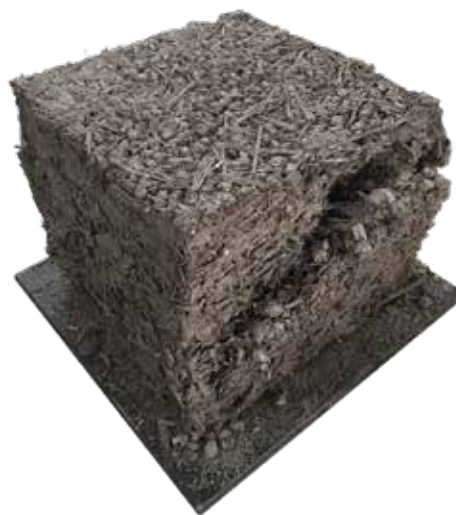
Fig. 7.12 Collasso del provino 3.1.3.
