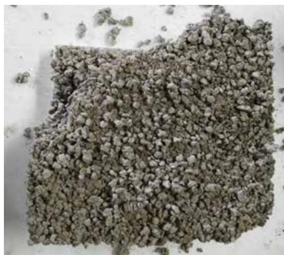
Fig. 6.19 Disgregazione degli angoli.
