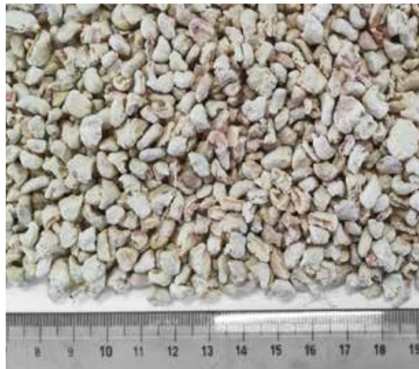
Fig. 6.15 Granulometria Silco 2-6,3 mm.
