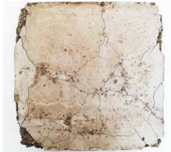
Fig. 6.23 Fessurazione del cemento nel provino 23.
