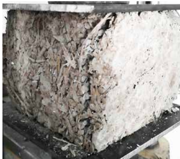
Fig. 7.7 Fessurazione del campione 4.1.1.
