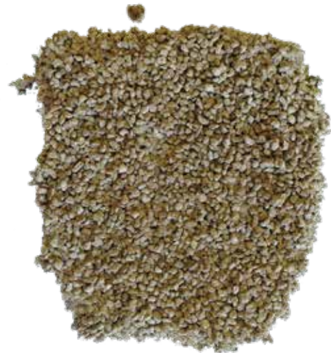
Fig. 6.20 Disgregazione del provino 9.
