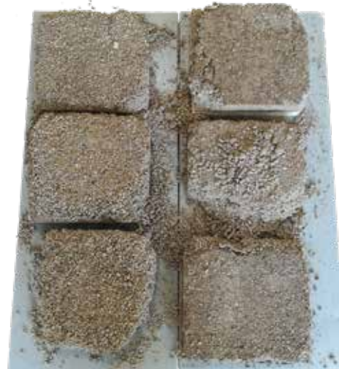
Fig. 6.22 Disgregazione dei mix design.
