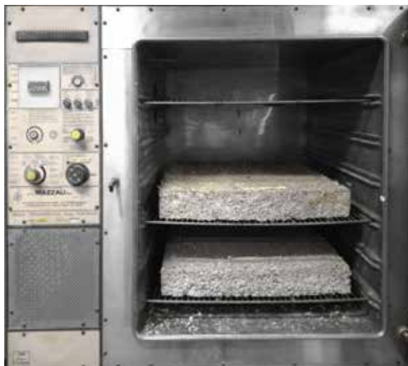
Fig. 7.6 Essiccazione delle losanghe in forno a T=50 °C.
