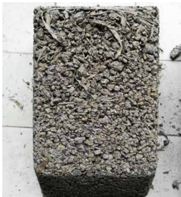
Fig. 6.11 Provino 2: granulometria calibrata con sfalci.
