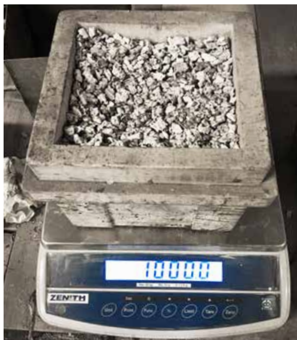
Fig. 6.13 Misura della massa volumica apparente sul campione 3 di tutolo.
