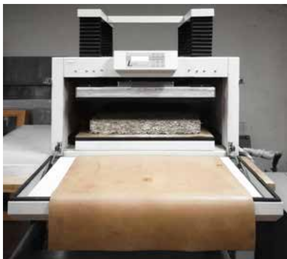
Fig. 7.7 Piastra calda con anello di guardia Lasercomp Fox600.
