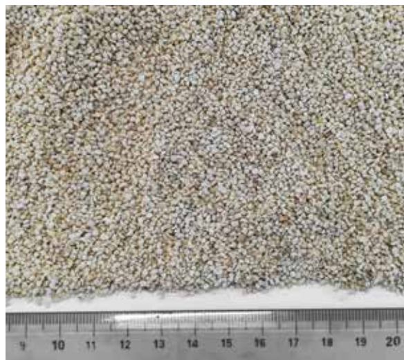
Fig. 6.16 Granulometria Silco 0,85-1,04 mm.
