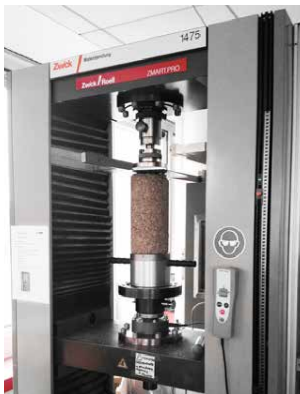
Fig. 7.2 Test sui provini con maturazione di 30 giorni mediante Pressa Zwick/Roell ZMART.PRO 1475.
