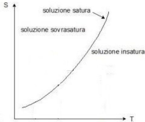
Figura 1.12: Andamento generale della solubilità in funzione della temperatura (dove S è la solubilità e T la temperatura).
