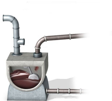
Figura 1.10: Schema macchina per il concaggio (Immagine tratta da www.focus.it )
