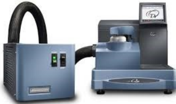
Figura 2.1: DSC Q200 (Immagine tratta da www.tainstruments.com )
