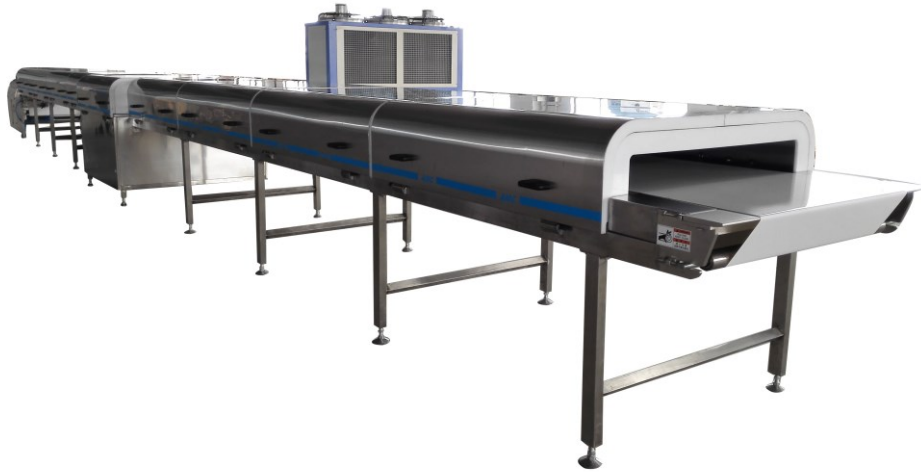
Figura 1.18: Esempio tunnel di raffreddamento per la solidificazione del cioccolato (Immagine tratta da www.coolingtunnelsystem.com )
