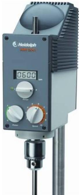
Figura 3.5 - Agitatore meccanico Heidolph RZR 2041
