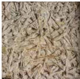
**FIBRA DI CELLULOSA:** Realizzata dal riciclo della carta di giornale, è stata utilizzata come isolamento nella copertura (con uno spessore di 45 cm) e nei solai contro terra (con uno spessore di 22,5 cm). È stata insufflata con un'apposita macchina, creando uno strato continuo.
