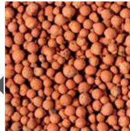
**ARGILLA ESPANSA:** 12 cm di argilla espansa sono stati utilizzati negli ambienti 2,5 e 6 come base per la pavimentazione.
