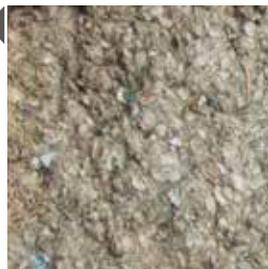
**LANA DI PECORA:** Principale materiale isolante nell'edificio, inserita nelle cavità del telaio ligneo delle pareti esterne e nella scala con uno spessore di 32,5 cm e una densità di 25 kg/m<sup>3</sup>.
