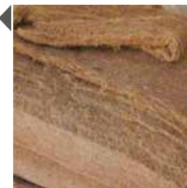
**FIBRA DI CELLULOSA:** Impiegata come isolamento interno delle pareti esterne, con spessori da 6 a 11 cm (230,4 m<sup>2</sup>) e in alcuni casi 19-20 cm (25 m<sup>2</sup>). È poi presente come isolamento della copertura, con spessore di 15 cm nell'ambiente non riscaldato e 14 e 18 cm in quello della mansarda, tra i travetti del nuovo solaio tra il secondo piano e il sottotetto e nelle pavimentazioni del piano terra.
