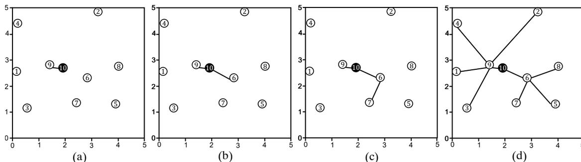
**Figure 3.3:** Example of tree construction using BIP: (a) step 1:  $10 \rightarrow 9$ ; (b) step 2:  $10 \rightarrow 6$ ; (c) step 3:  $6 \rightarrow 7$ ; (d) final tree.
