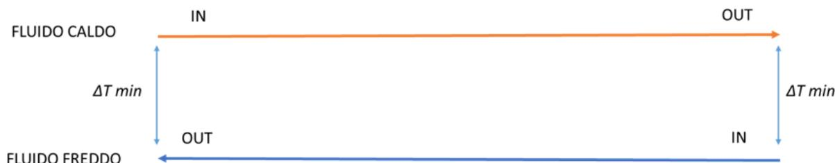
Figura 42 Rappresentazione schematica di uno scambiatore controcorrente utile alla compressione del vincolo della differenza minima di temperatura fra fluido caldo e freddo
