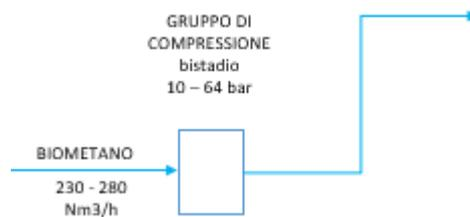
Figura 39 Schema del gruppo di compressione per biometano
