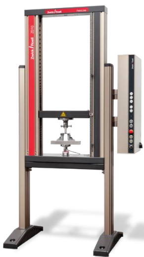
Figura 25 - Dinamometro Zwick/Roell Z010 a sinistra, estensimetri meccanici a destra
