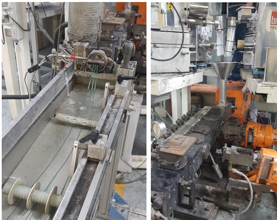
Figura 15 - Vasca di raffreddamento a sinistra; Tramoggia e corpo principale a destra
