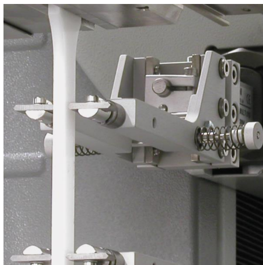
Figura 25 - Dinamometro Zwick/Roell Z010 a sinistra, estensimetri meccanici a destra
