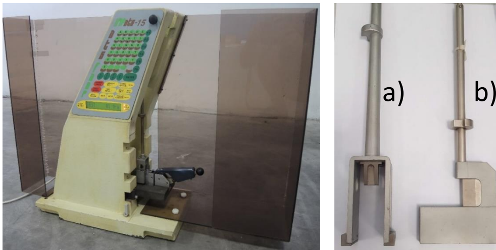
Figura 27 - a sinistra Macchina per test IZOD e Charpy ATS FAAR impacts 15. a destra con: a) mazza 1 J per Izod; b) mazza 1 J per Charpy
