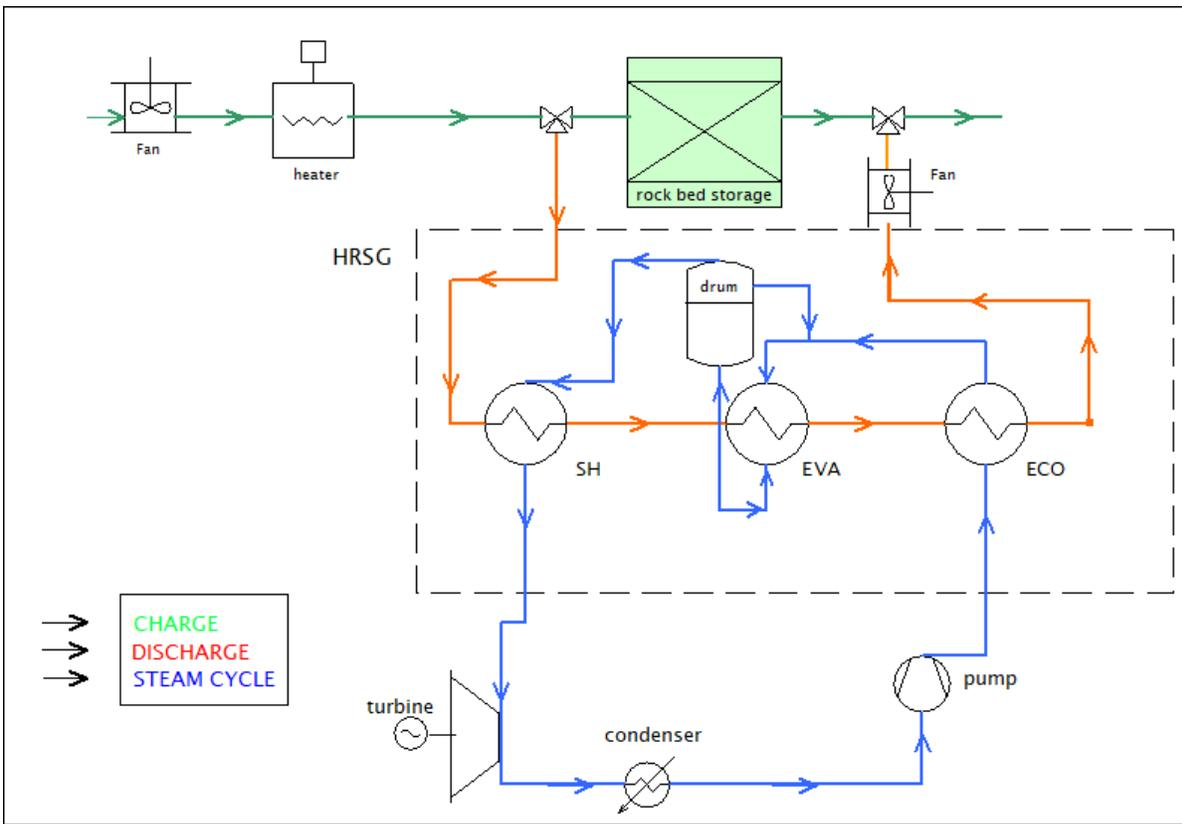
FIGURE 11 TYPE ONE - SIMPLE STEAM TURBINE IN DISCHARGE PHASE.
