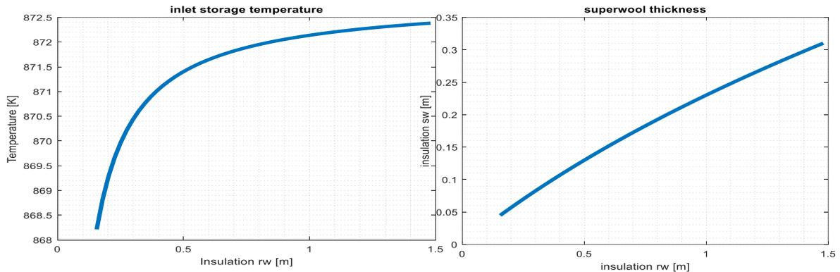
FIGURE 55 INLET STORAGE TEMPERATURE. THE GRAPH SHOW TAT THE TEMPERATURE DROP VERY LOW DUE TO GREAT ROCKWOOL AND SUPERWOOL INSULATION CHARACTERISTICS. FIGURE 54 IT IS THE SUPERWOOL THICKNESS. MORE THE ROCKWOOL THICKNESS IS HIGHER AND MORE THE SUPERWOOL IS HOGHER. THAT IS MEANS THAT THERE IS AN HIGH HEAT FUX THAT IT IS LOST THROUGHT THE INSULATION SURFACES.
