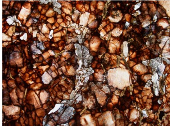
**FIGURE 7 SWEDISH DIABASE AFTER THE THERMOCHEMICAL CYCLE<sup>12</sup>**
