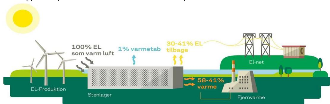
**FIGURE 9 POWER-TO-POWER PLANT OVERVIEW<sup>13</sup>**
