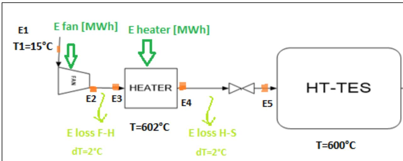
FIGURE 35 CHARGE HEAT FLUXES.
