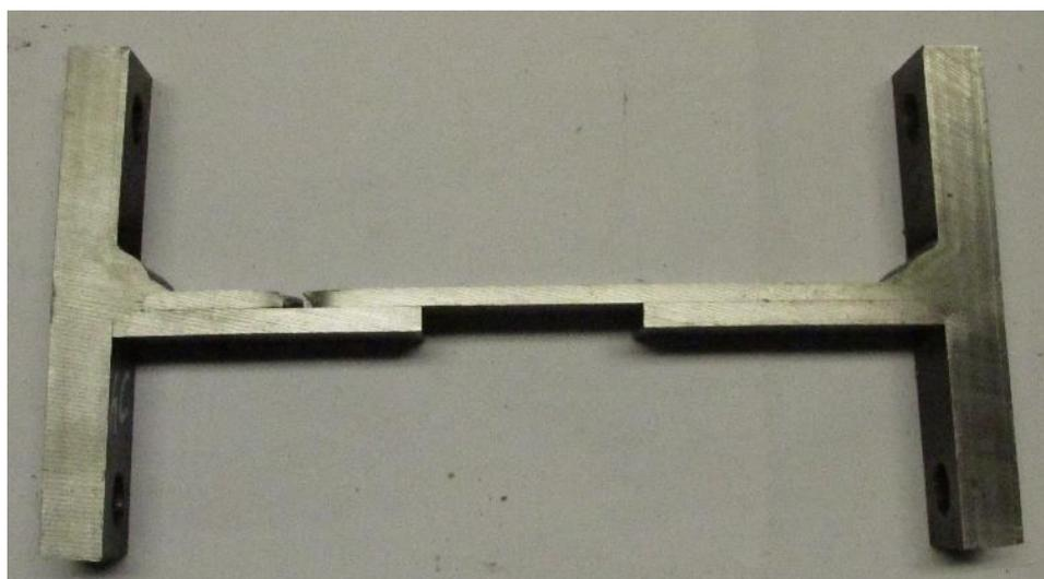
**Figura 3.46** Provino 4 dopo la prova di trazione.
