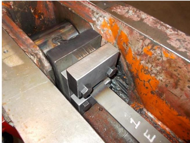
**Figura 3.35** Dettaglio montaggio delle attrezzature di vincolo del provino al banco di prova.
