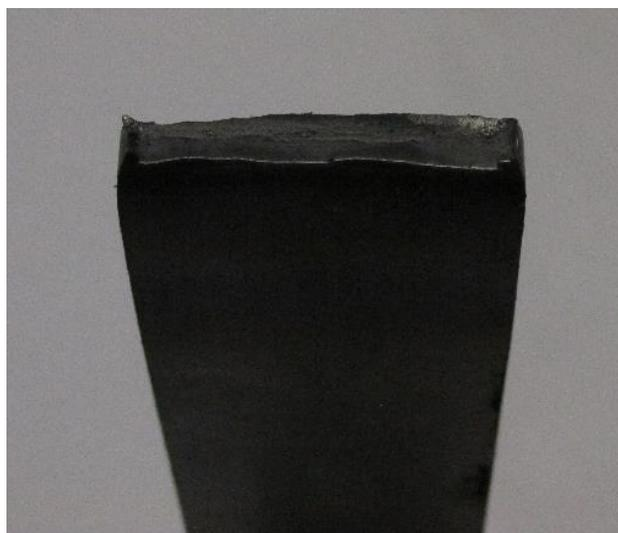
**Figura 3.42** Zoom della zona di rottura del Provino 2, lamiera sottile.
