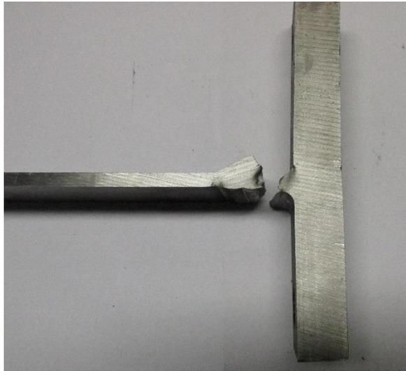
**Figura 3.33** Provino 1 dopo la prova di trazione.
