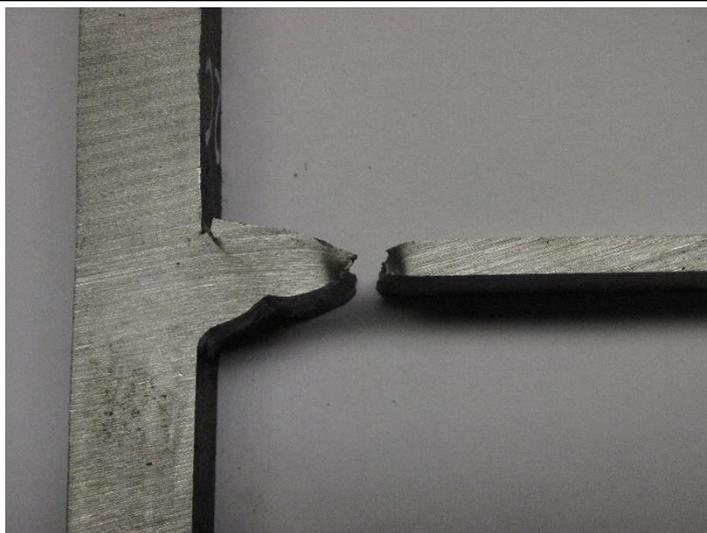
**Figura 3.40** Provino 2 dopo la prova di trazione, zoom nella zona di rottura.
