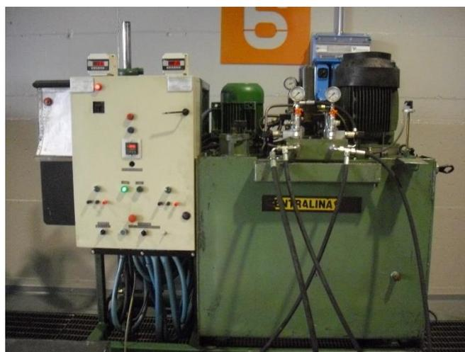
Figura 3.32 Centralina utilizzata per effettuare le prove
