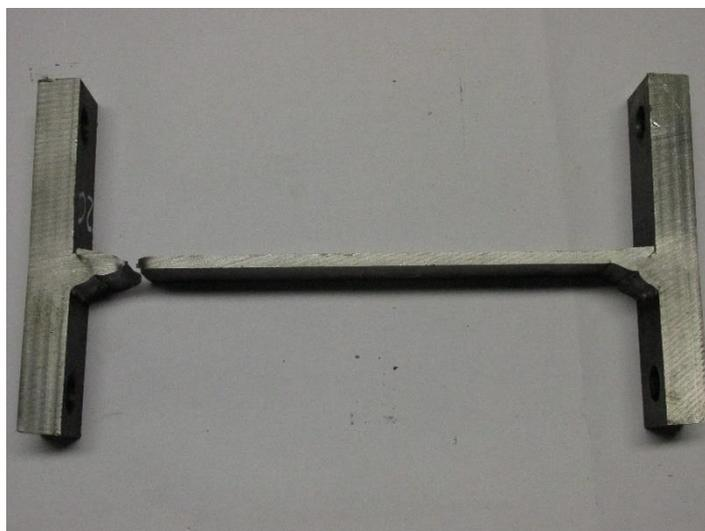
**Figura 3.39** Provino 2 dopo la prova di trazione.
