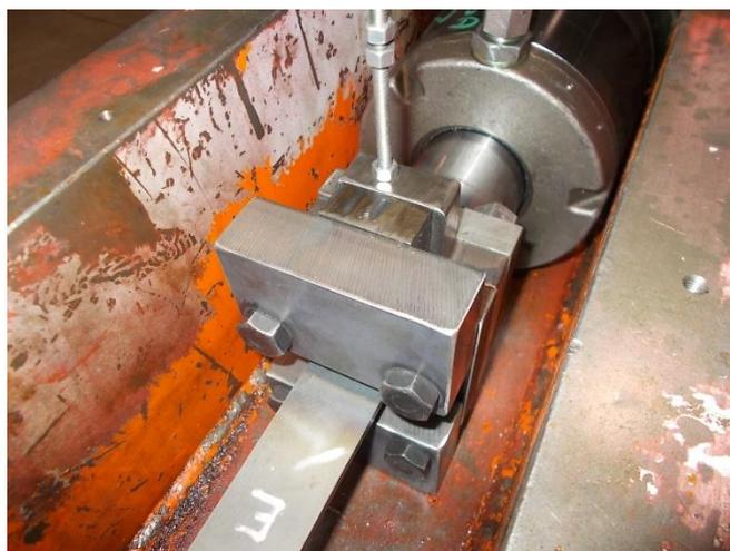
**Figura 3.34** Dettaglio montaggio attrezzature d'ancoraggio del provino allo stelo del martinetto idraulico.
