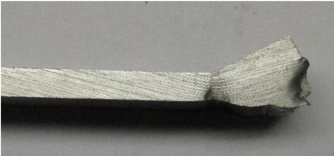
**Figura 3.34** Zoom nella zona di rottura del Provino 1, lembo lamiera.
