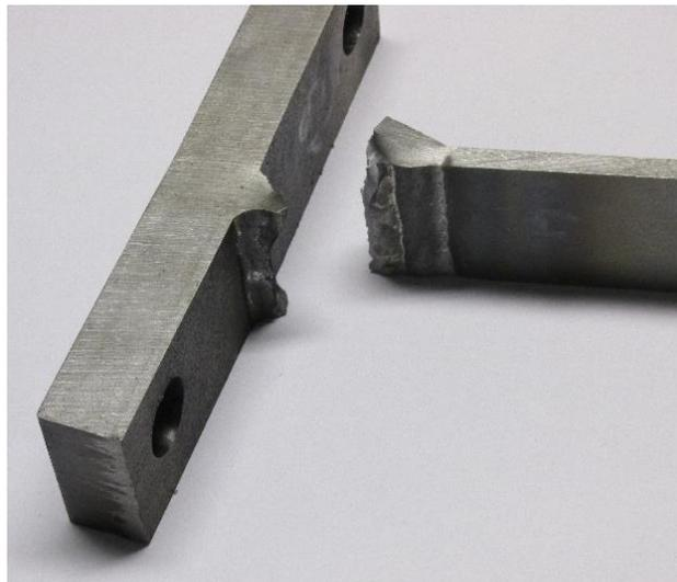
**Figura 3.37** Zoom nella zona di rottura del Provino 1.
