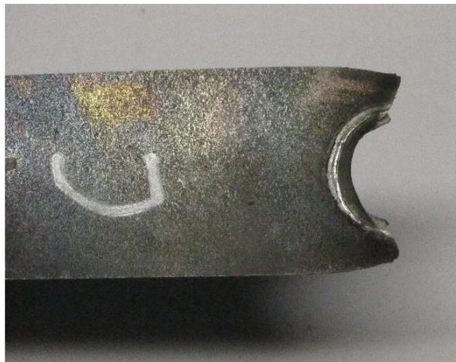
**Figura 3.48** Provino 4 dopo la prova di trazione, zoom nella zona di rottura, lamiera sottile snervata.
