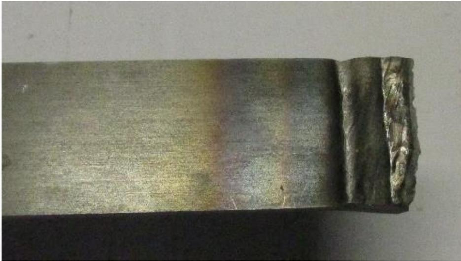
**Figura 3.36** Zoom della zona di rottura del Provino 1 vista frontale evidenziando la strizione.
