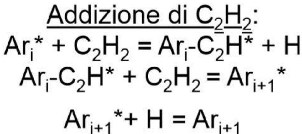
Figura 2.13 Secondo step di reazione del meccanismo HACA
