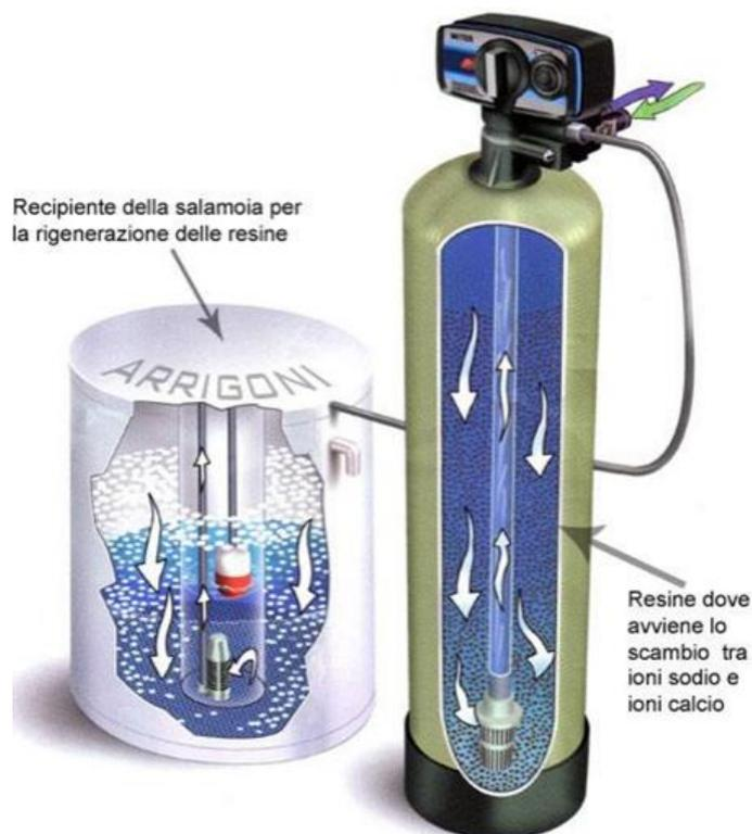
Fig. 5.8.1 – Schema di un impianto di addolcimento dell'acqua
