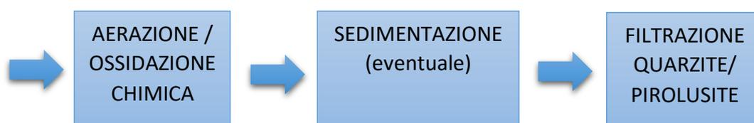
Fig. 4.2.1 – Schema di trattamento acqua con ferro e manganese in concentrazioni eccessive
