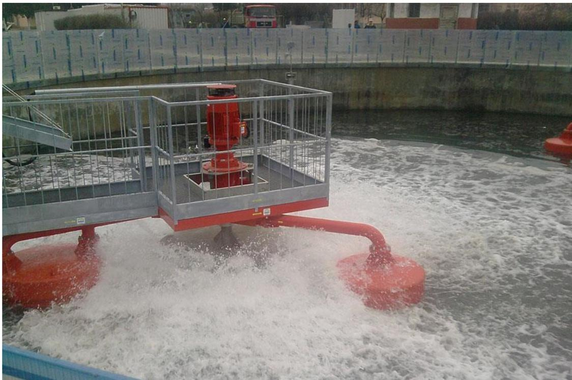
*Fig. 6.1.1 - Esempio di sistema di aerazione in superficie*
