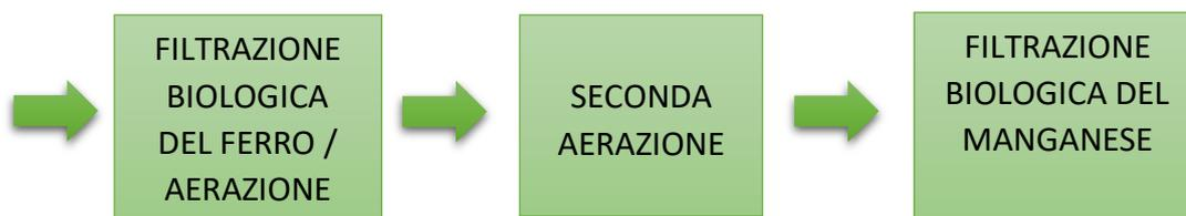
Fig. 4.3.2 – Schema di un tipico trattamento biologico di acqua con forte presenza di ferro e manganese
