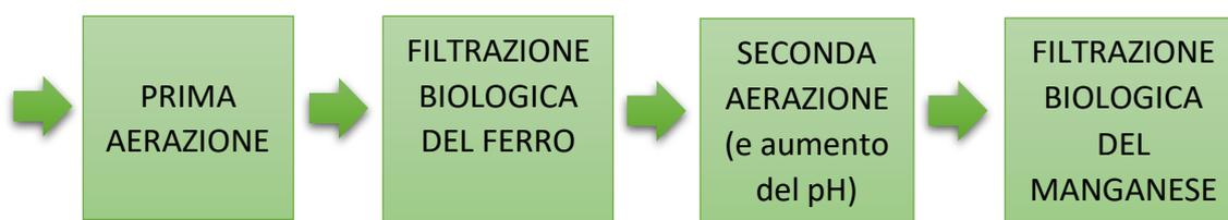
Fig. 4.3.3 – Un altro schema di un tipico trattamento biologico di acqua con forte presenza di ferro e manganese
