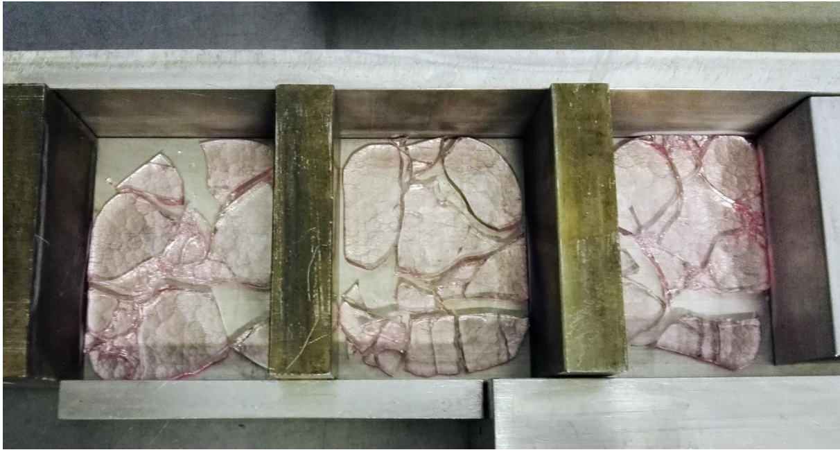
Figura 4.1: Fotografia dei tre vetri criccati dopo la prima colata.
