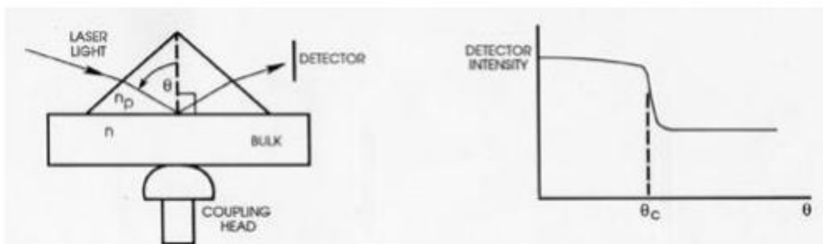
Figura 4.9: Principio di funzionamento della misura dell'indice di rifrazione tramite tecnica di accoppiamento prismatico ed esempio di segnale ottenuto da tale misura.
