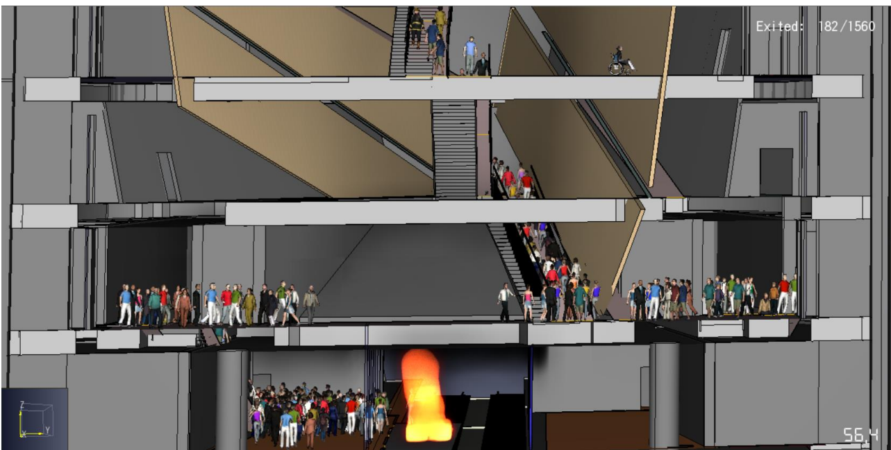
Figura 83: Accoppiamento simulazioni di incendio e di evacuazione
