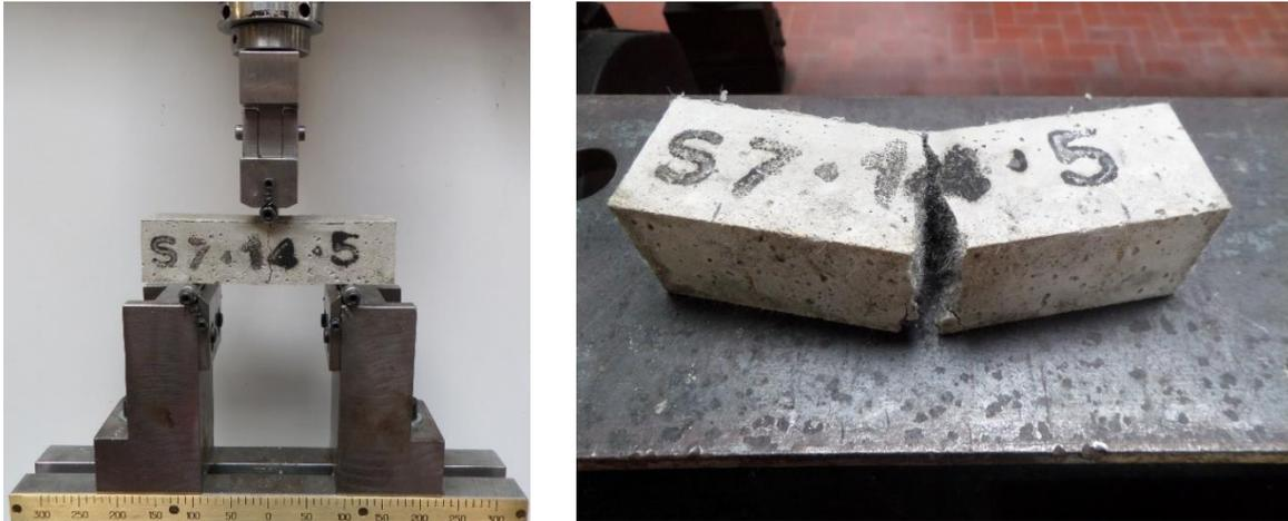
**Figura 4.15** - Esempio di fessurazione ( $sx$ ) e rottura per flessione ( $dx$ ) di un provino prismatico
