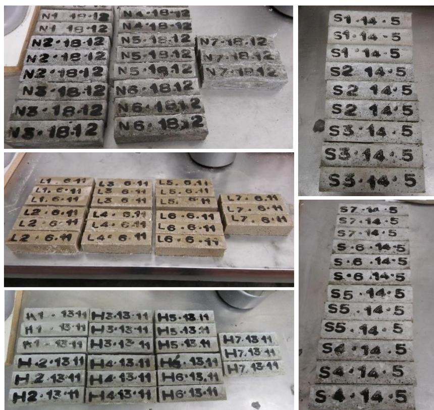
**Figura 4.11** – Provini costituiti dalle varie miscele (N, L, H, S) dopo il disarmo, opportunamente marcati con codice identificativo e la data di confezionamento
