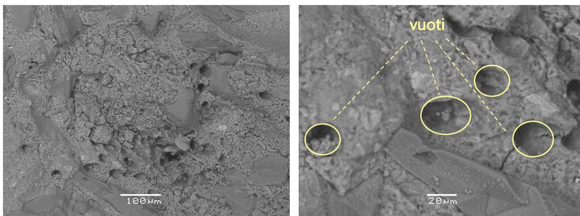
**Figura 5.12** - Porzione di un provino H4, con stagionatura a 27 giorni in acqua, in cui sono visibili vuoti nella matrice cementizia al posto delle fibre di lana
