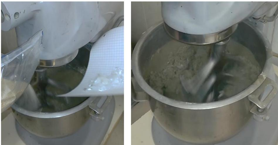
**Figura 4.6** - Fase di miscelazione in laboratorio
