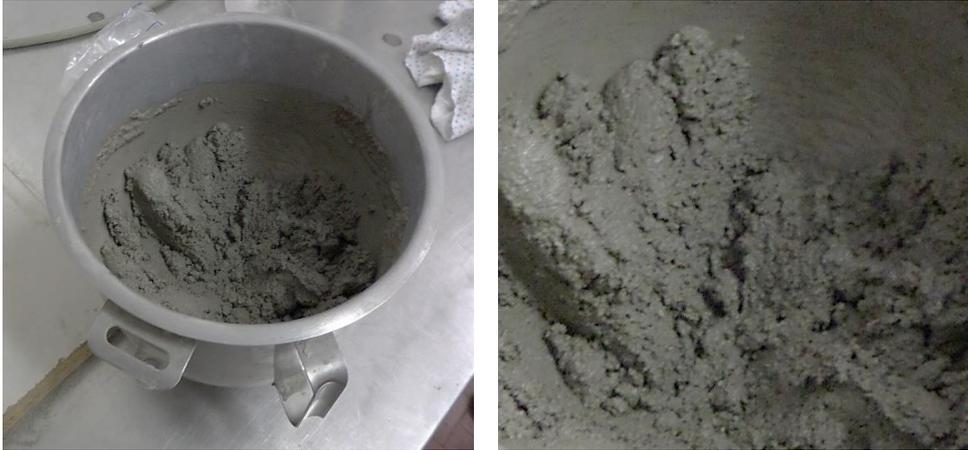
**Figura 4.7** – Esempio di impasto finale della malta cementizia fibrorinforzata
