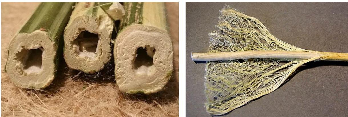
**Figura 3.18** - Estrazione delle fibre di canapa dal fusto ligneo
