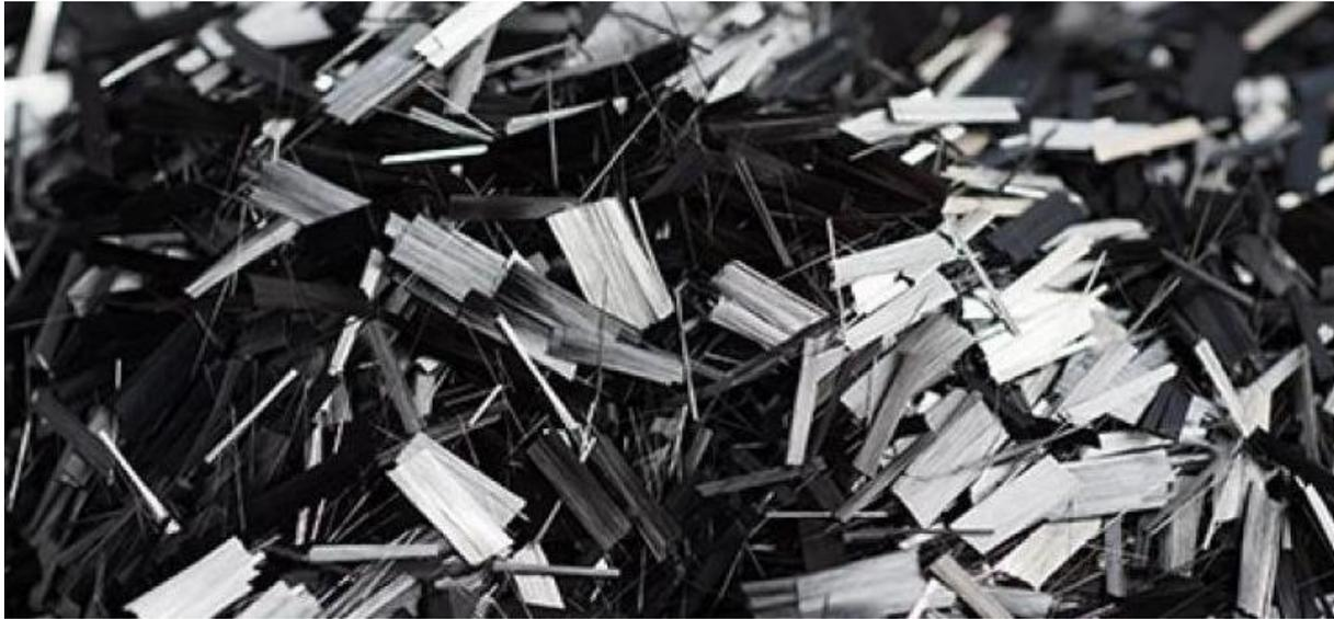
**Figura 3.12** - Esempio di fibre di carbonio per FRC
