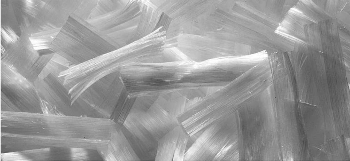
**Figura 3.10** – Esempio di fibre di polipropilene per FRC
