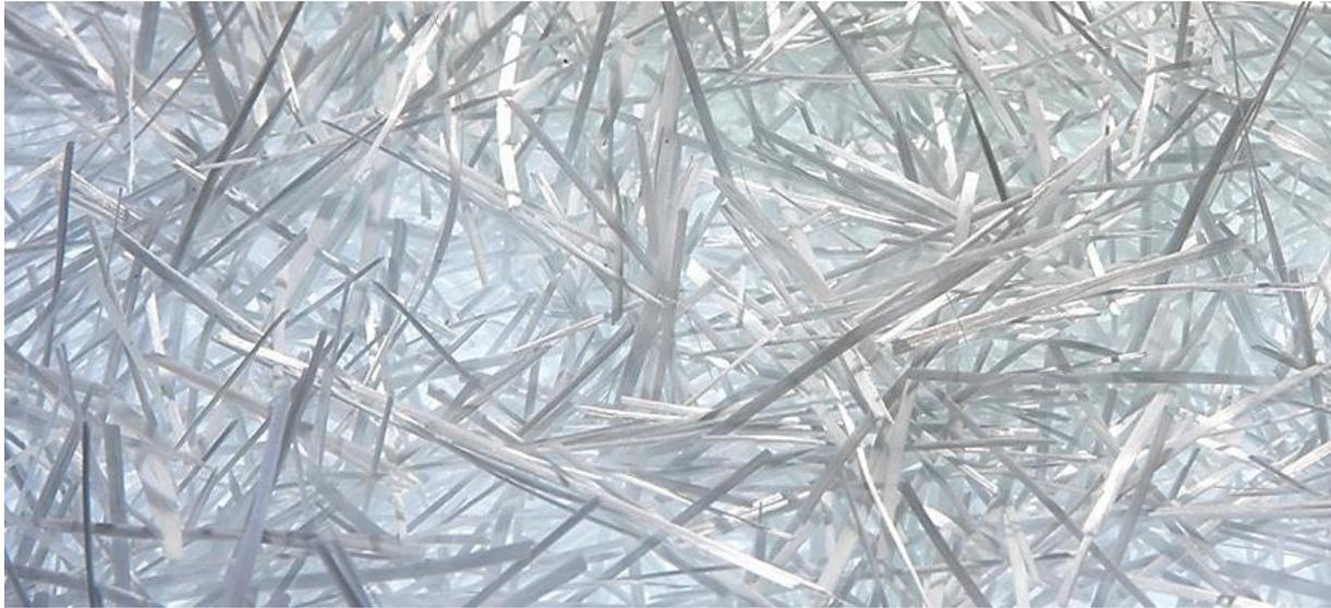
**Figura 3.6** - Esempio di fibre di vetro per FRC
