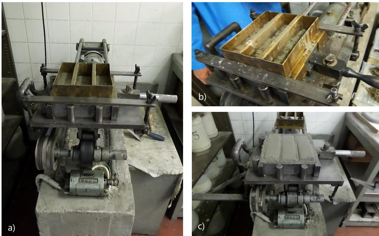
**Figura 4.9** - Fasi relative alla formatura dei provini: a) macchina compattatrice a battente; b) compattazione della malta cementizia; c) realizzazione dei provini prismatici
