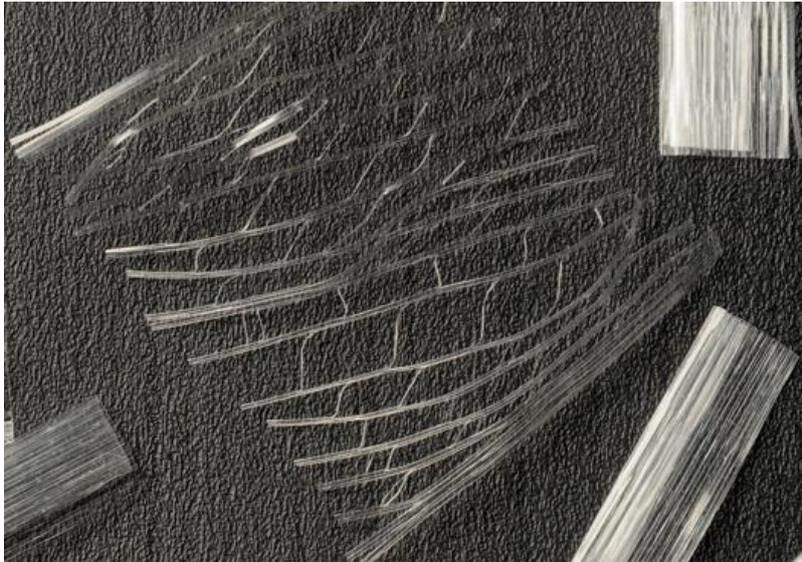
**Figura 3.11** - Esempio di fibra di polipropilene fibrillata
