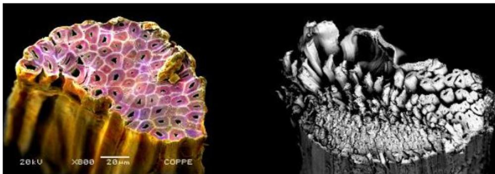
**Figura 3.27** - Schematizzazione dell'effetto di degradazione delle fibre naturali in ambiente alcalino, in alto, tratto da (Bentur,2014) [9] e immagine al SEM della degradazione di una fibra di sisal, in basso
