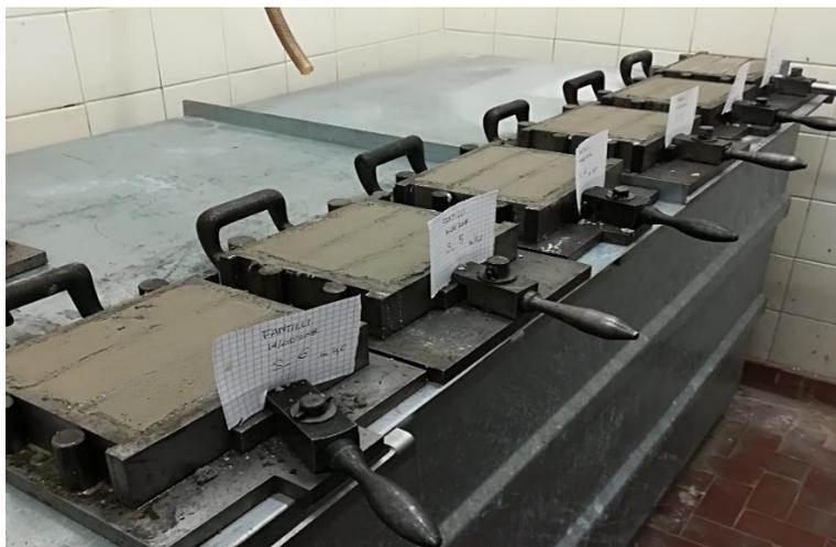
**Figura 4.10** – Collocazione dei provini nella camera umida del laboratorio
