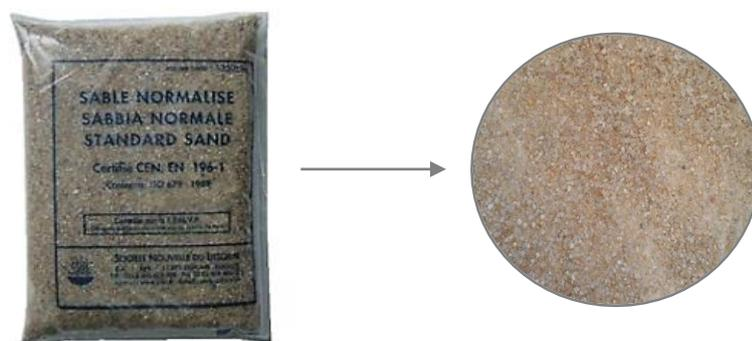
**Figura 4.1** - *Sabbia normalizzata CEN, con dettaglio a destra della granulometria*
