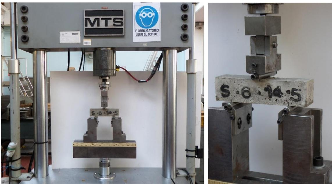
**Figura 4.13** - Macchina di prova universale MTS con dettaglio dell'elemento di ripartizione del carico
