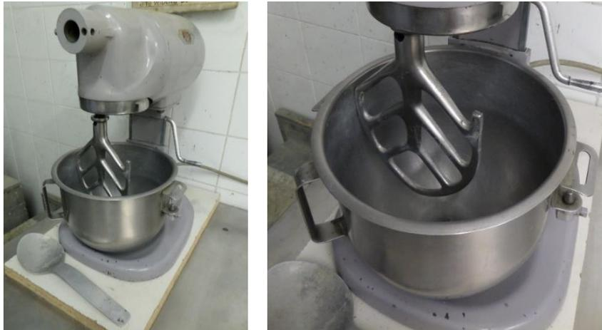
**Figura 4.5** - Mescolatrice utilizzata in laboratorio, con dettaglio della pala
