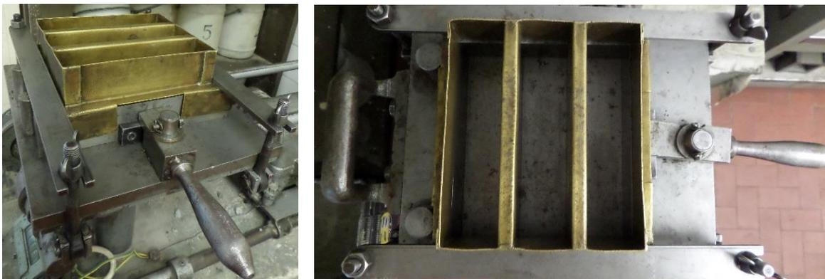
**Figura 4.8** - Cassaforma utilizzata per il confezionamento dei provini
