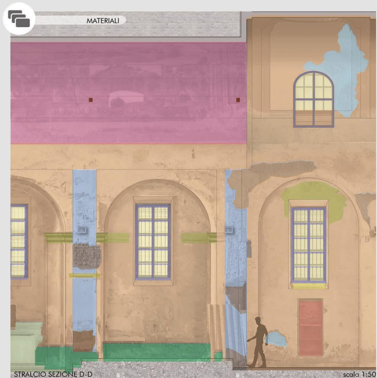
Fig 7. Stralcio sezione fuori scala con indicazione dei materiali – scala originale 1:50
