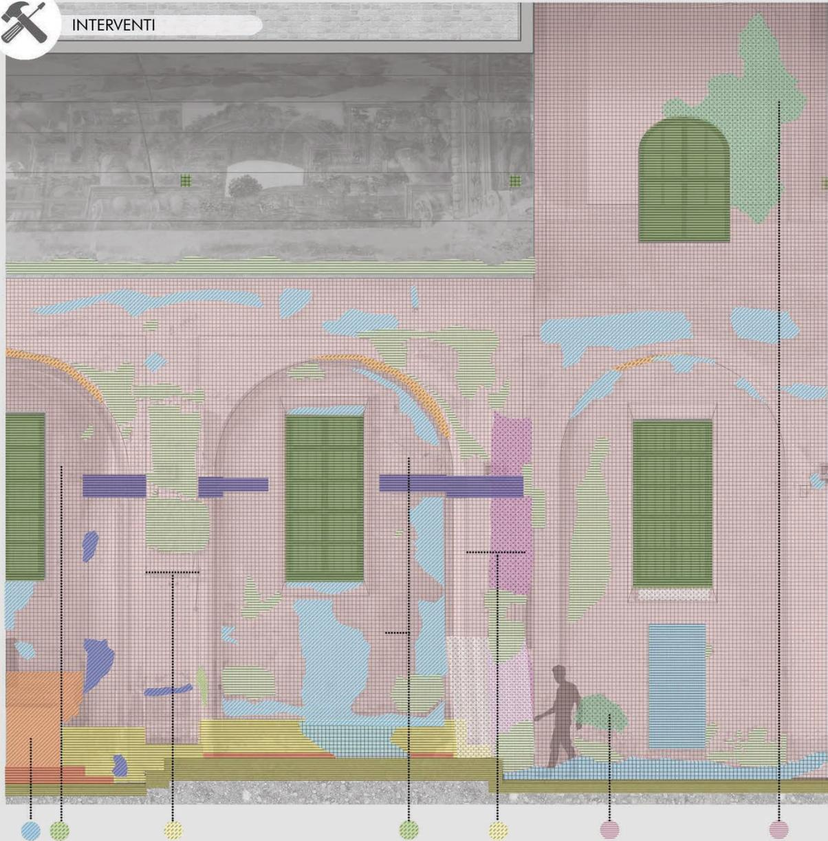
Fig 9. Stralcio sezione fuori scala con indicazione dei possibili interventi – scala originale 1:50
