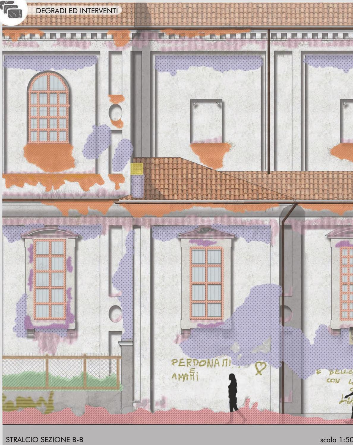
Fig 11. Stralcio sezione della facciata su via Carducci fuori scala con indicazione dei degradi – scala originale 1:50
