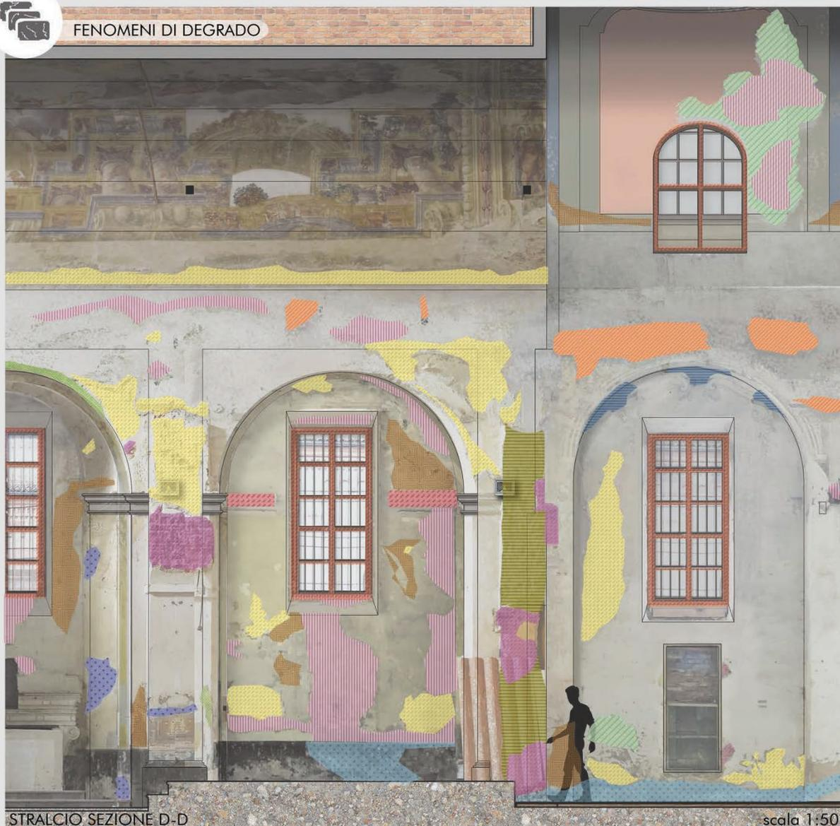
Fig 8. Stralcio sezione fuori scala con indicazione dei fenomeni di degrado – scala originale 1:50
