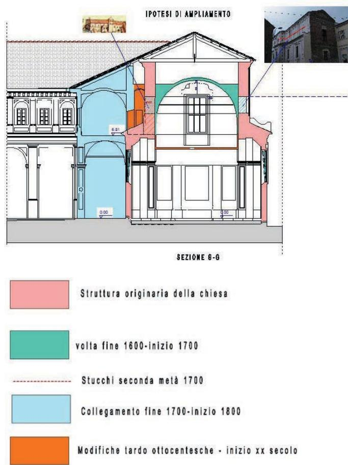
**Fig 14.** Sezione fuori scala con individuazione delle principali fasi storiche di costruzione.
