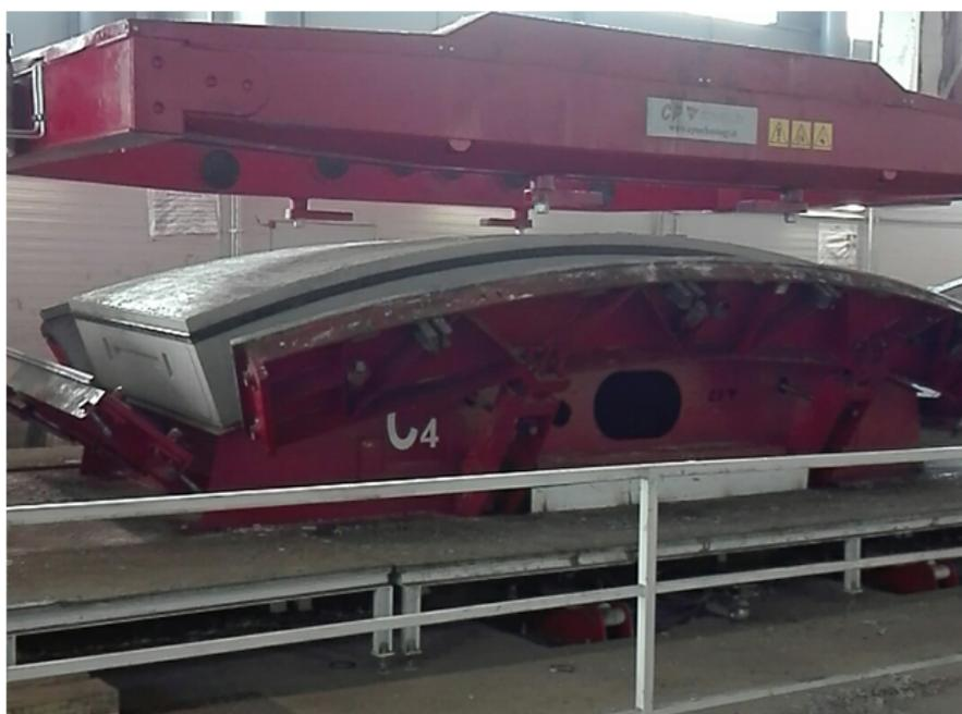
Figura 3.19. Dettaglio della fase di rimozione del cassero all'interno di un impianto produttivo
