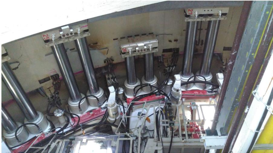
Figura 3.24. Dettaglio dei martinetti di spinta di una TBM tipo EPB
