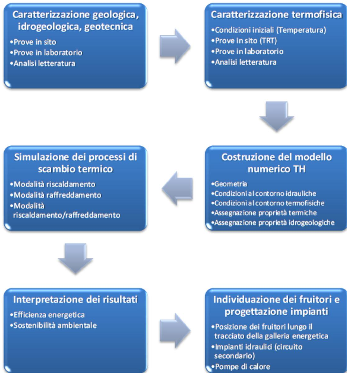
Figura 4.1. Impianto metodologico *thermal design*
