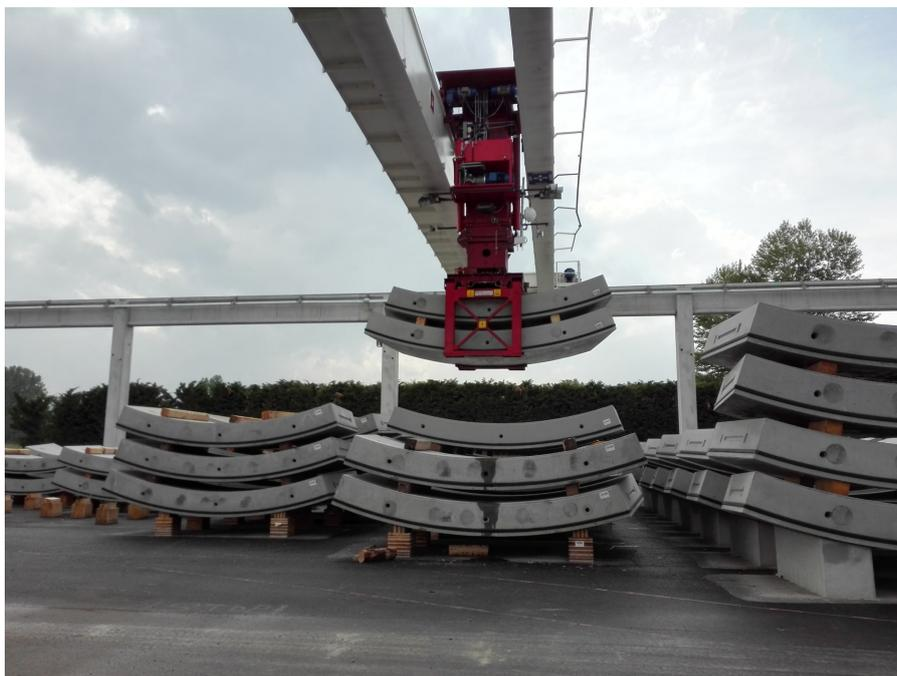
Figura 3.22. Esempio di stoccaggio tramite impilaggio dei conci prefabbricati in un impianto di produzione
