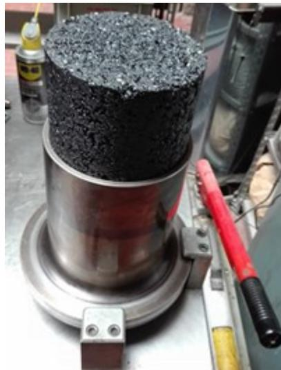
*Figura 3-19: Estrazione del campione della fustella*
