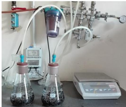
*Figura 3-26: Picnometro riempito con miscela ed acqua distillate e collegato alla pompa*
