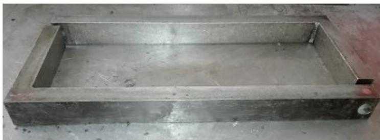
*Figura 3-21: Forma del cassero utilizzato per le lastre*
