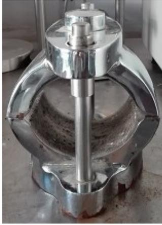
*Figura 3-23: Testa di rottura per provini*
