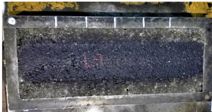
Figura 4-10: Lastra L7 dopo Wheel Tracking Test a 60°C
