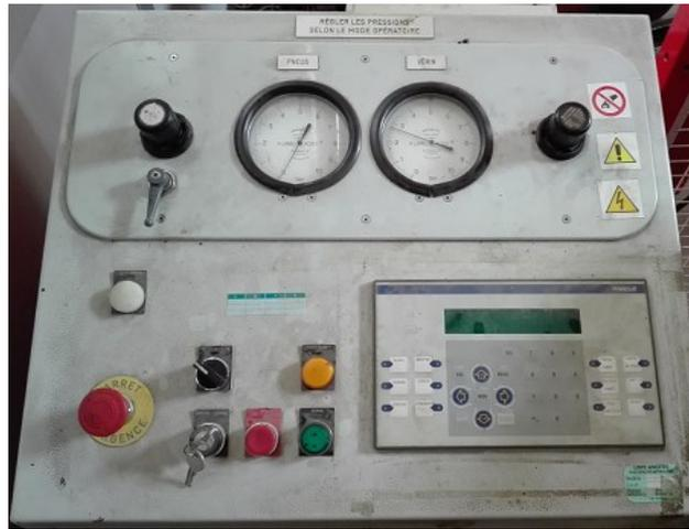
Figura 3-41: Pannello di controllo di compattatore a lastre
