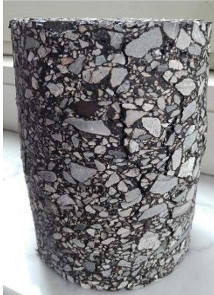
Figura 4-19: Campione testato a 60°C
