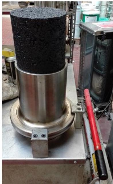
*Figura 3-36: Estrusore che permette sfilare il campione dalla fustella*
