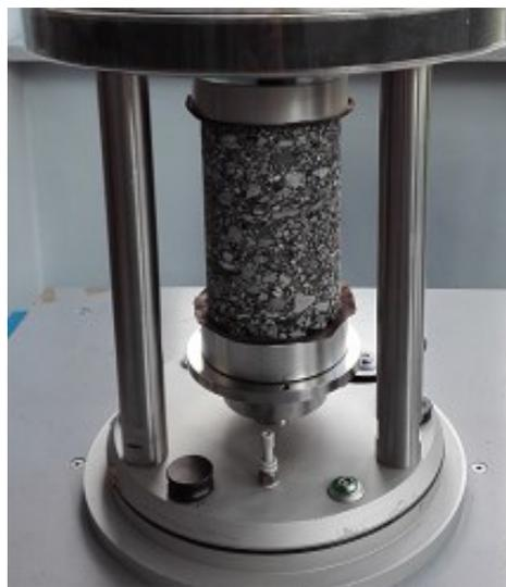
*Figura 3-59: Campione pronto per essere testato*
