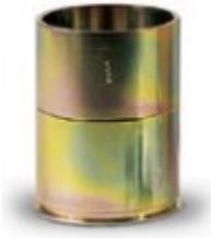
*Figura 3-10: Stampo Marshall completo di base e collare*
