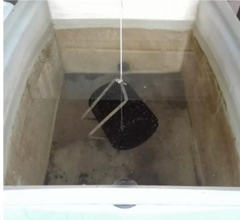
*Figura 3-40: Bilancia con la quale viene effettuata la pesata idrostatica del campione*
