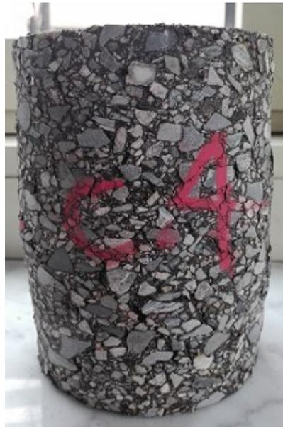
Figura 4-17: Campione testato a 40°C
