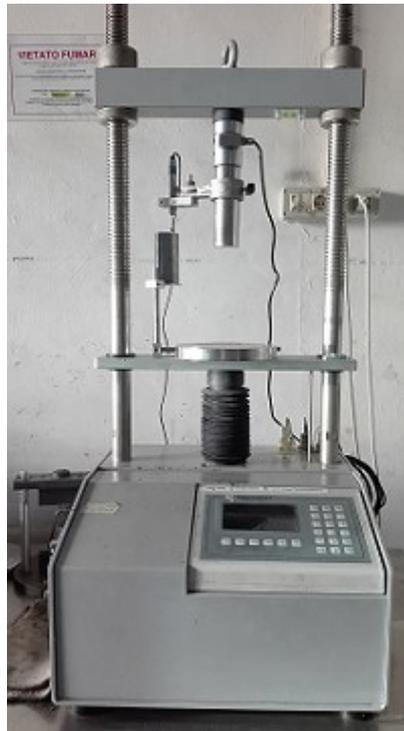
*Figura 3-22: Pressa attrezzata per prova Marshall*
