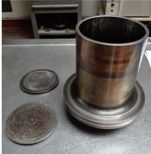
*Figura 3-17: Fustella cilindrica metallica utilizzata per la compattazione con la Pressa Giratoria*
