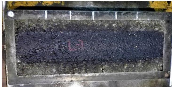
*Figura 3-48: Lastra testata dopo il Wheel Tracking Test*
