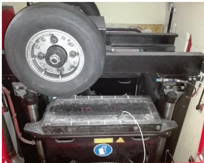
*Figura 3-13: French Rutting Tester con lastra testata*
