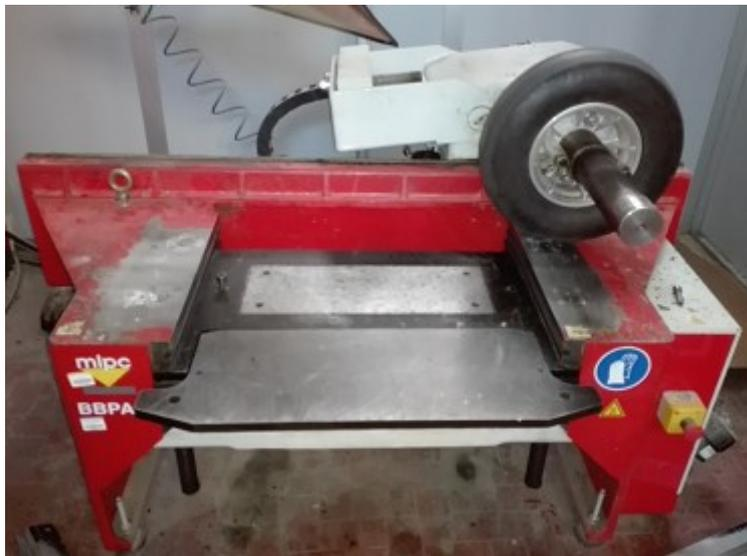
*Figura 3-20: Compattatore con uso di pneumatico*
