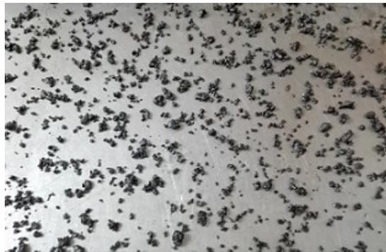
*Figura 3-25: Materiale bituminoso distribuito manualmente in grani*
