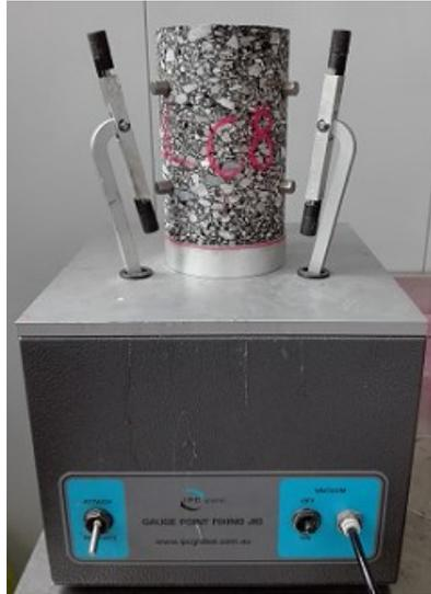
*Figura 3-51: Dima per montaggio spine di riferimento trasduttori LVDT*
