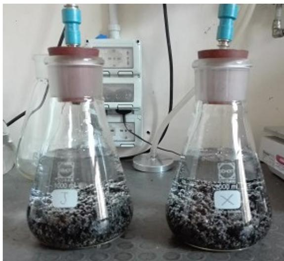
Figura 4-1: Picnometri riempiti con miscela e acqua distillate
