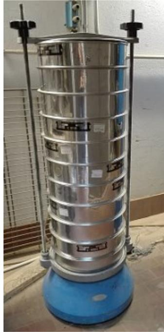
Figura 3-29: Pila di setacci in un agitatore meccanico
