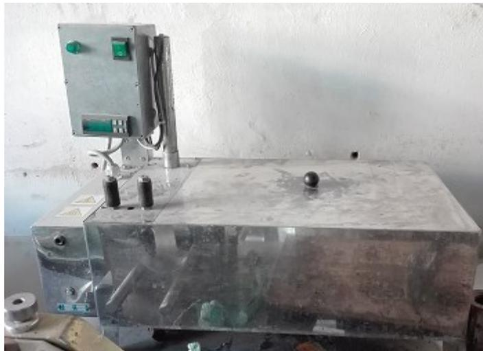
*Figura 3-11: Bagno termostatico per provini Marshall*
