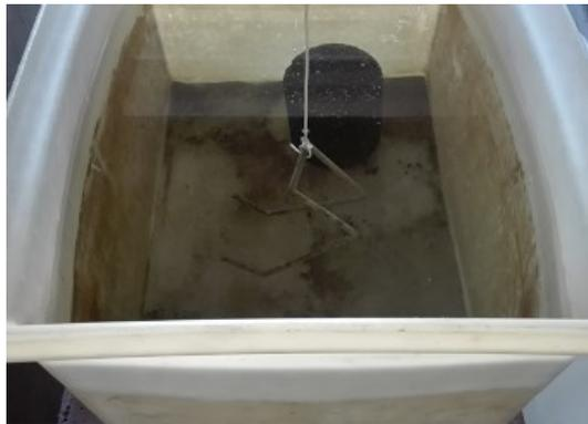
*Figura 3-39: Campione a bagno nell'acqua*
