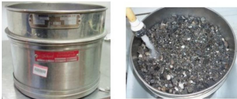
*Figura 3-28: Lavaggio degli aggregati post Carbolite impiegando setacci 2 e 0.063 mm*
