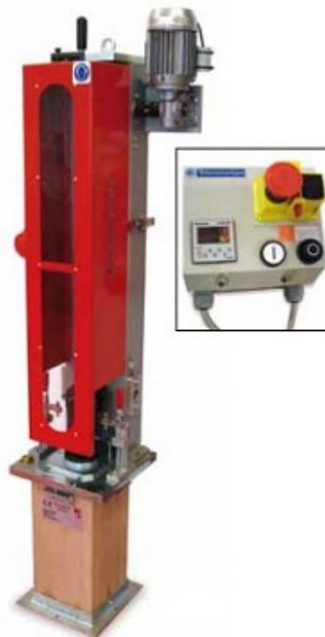
*Figura 3-9: Macchina di compattazione automatica per provini Marshall*
