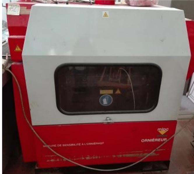
*Figura 3-12: French Rutting Tester-vista esterna della macchina*
