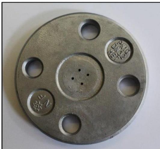
Figura 6.28 – Piastra a 4 fori, diametro 2,5 mm utilizzata durante gli studi di disinfezione con *E. coli*
