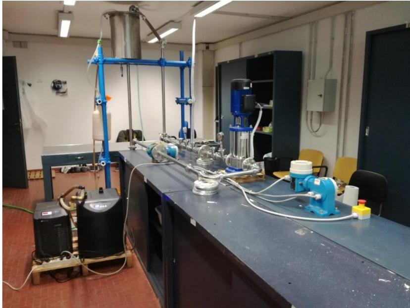
Figura 6.34 – Vista d'insieme dell'impianto cavitazionale (poggiato sul bancone) e dell'impianto di raffreddamento (sulla sinistra, nella fotografia)
