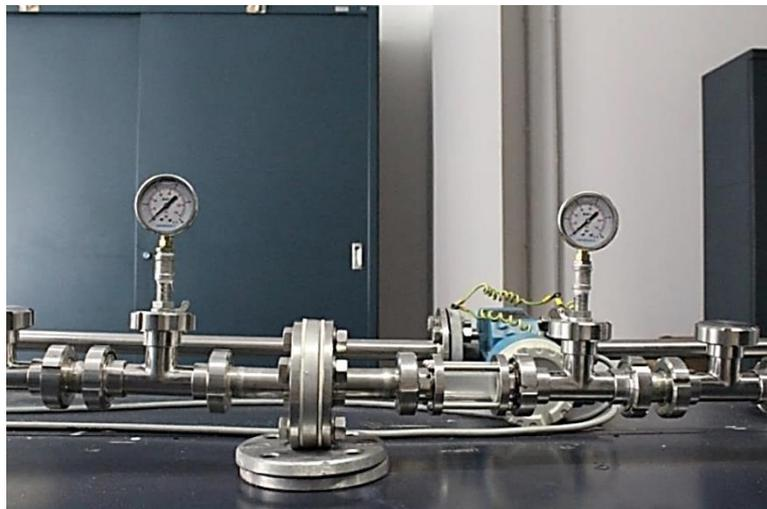
Figura 6.19 – Posizionamento dei manometri lungo il ramo di mandata dell'impianto; tra i due è possibile osservare la piastra forata e la specola di controllo (Garofano, 2016)
