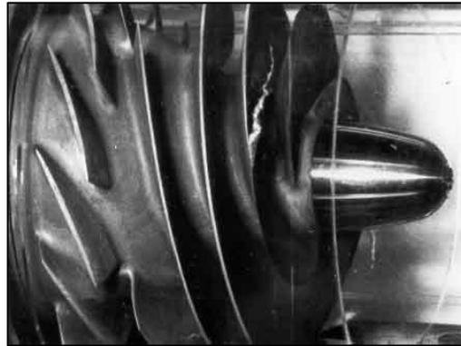
**Figura 3.13 – Vortici cavitazionali in un modello in scala della girante di una turbopompa a bassa pressione (Brennen, 1995)**
