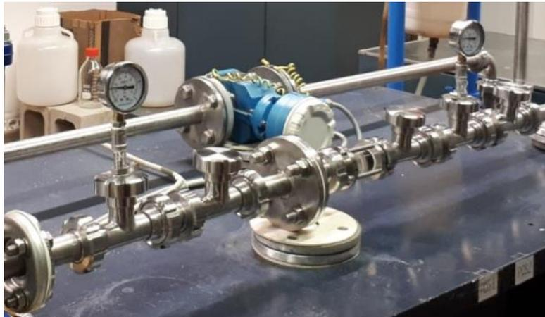
Figura 6.11 – Raccordi a T nel lato di mandata; alcuni risultano strumentati con manometri, altri chiusi con tappi
