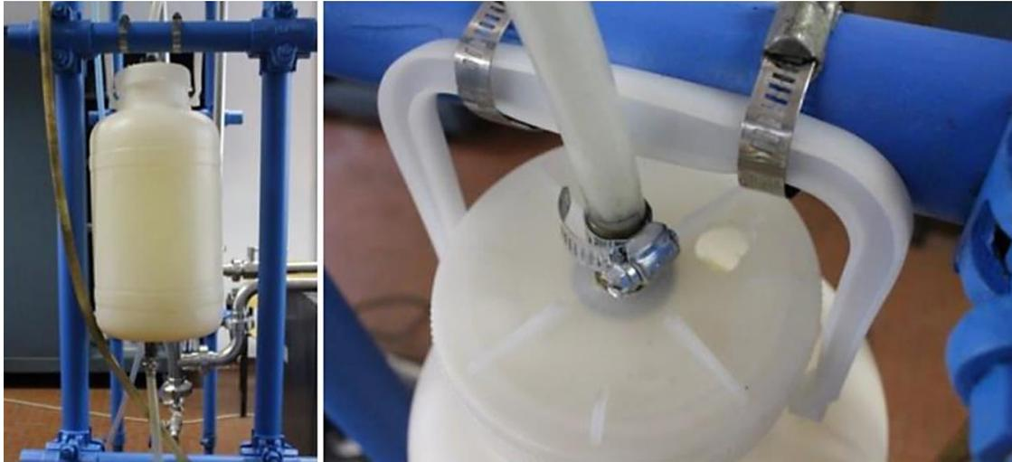
Figura 6.39 – Serbatoio di plastica per la raccolta dell'acqua in circolo nella serpentina. A destra sono visibili alcuni particolari: il tubo di ritorno, il foro per garantire la fuoriuscita dell'aria, le fascette di metallo per il fissaggio all'impalcatura (Garofano, 2016).
