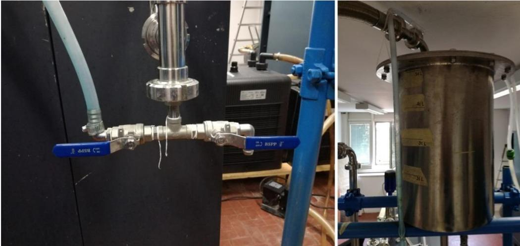
Figura 6.26 – Collegamento del piezometro al piego-gomma (a sinistra) ed indicazione dei livelli idrici all'interno del serbatoio (a destra)
