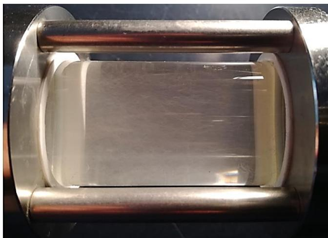
Figura 6.30 – Attività cavitazionale visibile attraverso la specola di vetro
