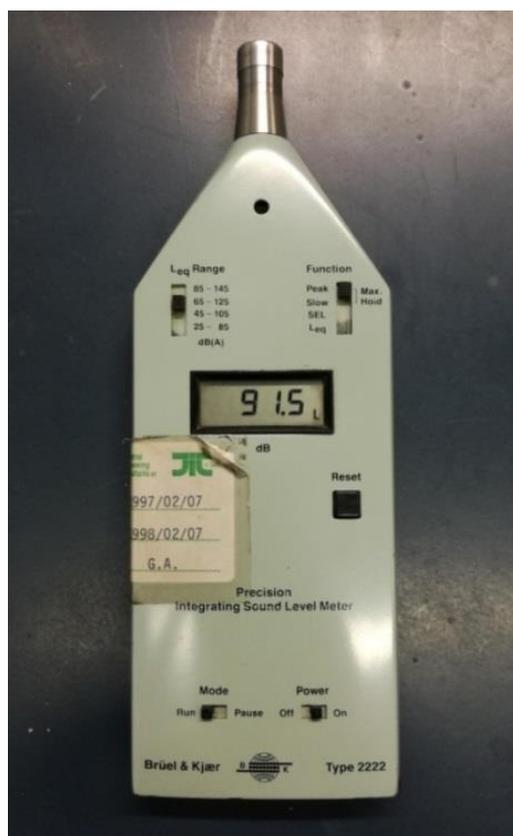
Figura 6.46 – Fonometro *Brüel & Kjær Type 2222* utilizzato durante gli esperimenti
