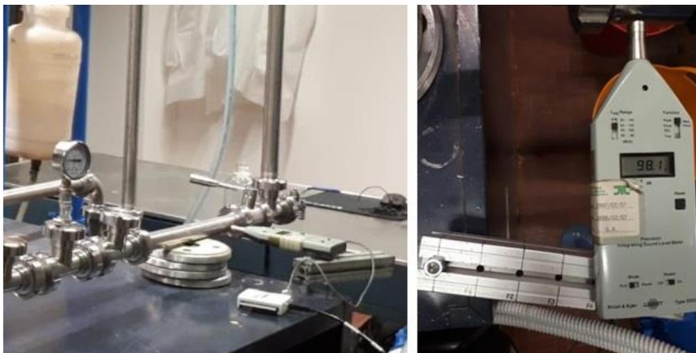
Figura 7.21 – Operazioni di registrazione con fonometro a monte della valvola a sfera (a sinistra) ed in corrispondenza della stessa (a destra)
