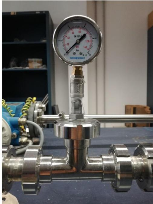
**Figura 6.20 – Manometro utilizzato per monitorare la pressione del fluido all'interno dell'impianto idraulico**
