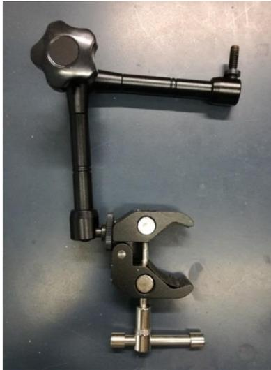
Figura 7.17 – Cavalletto con braccio snodato per il fissaggio del fonometro al bancone
