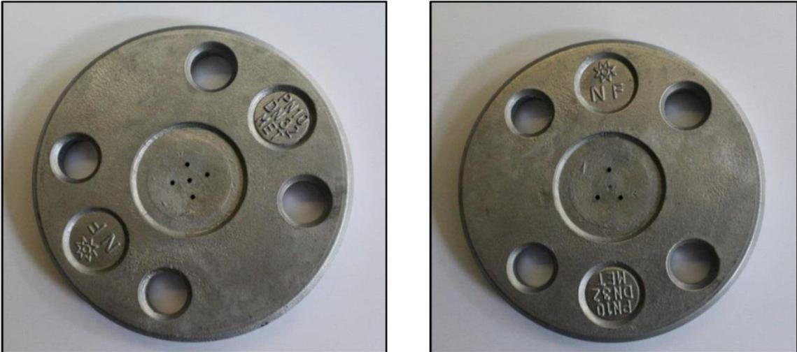
Figura 6.27 – Piastre a 5 e 3 fori i quali sono stati realizzati mediante un trapano a colonna dotato di una punta in cobalto da 2 mm di diametro (*Garofano, 2016*)
