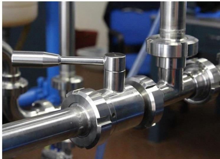
Figura 6.31 – Valvola a sfera per regolazione della pressione di valle (Garofano, 2016)
