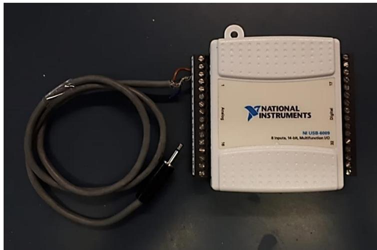
Figura 6.48 – Scheda di acquisizione dati *NI USB-6009*, con collegamento per il fonometro
