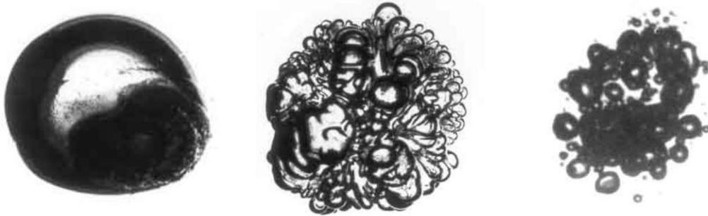
Figura 3.8 – Frammentazione di una bolla cavitazionale e conseguente formazione di una nuvola di microbolle
