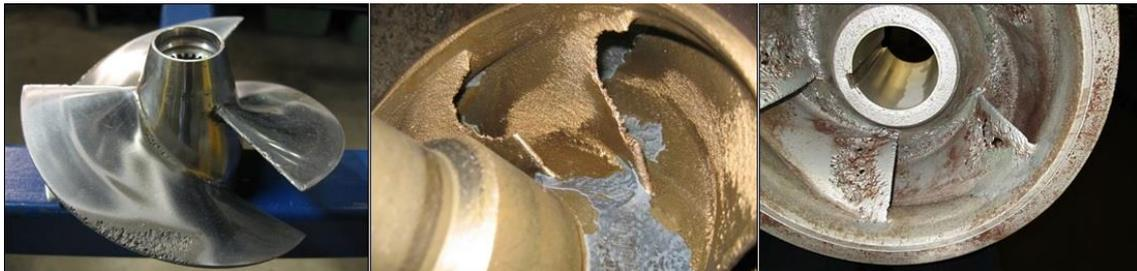
Figura 3.3 – Esempi di danni prodotti dalla cavitazione a eliche e giranti di pompe idrauliche
