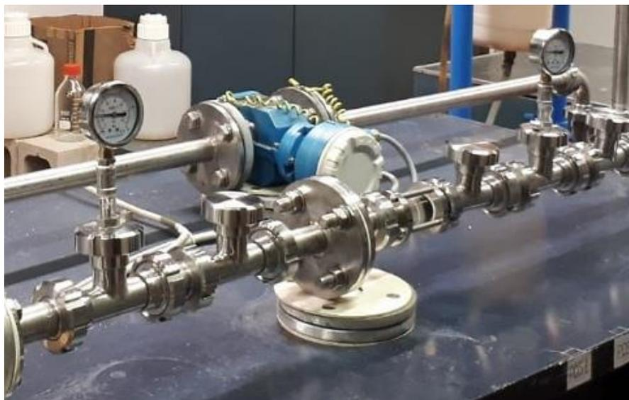
Figura 7.23 – Esperimento di controllo eseguito in assenza di piastra forata
