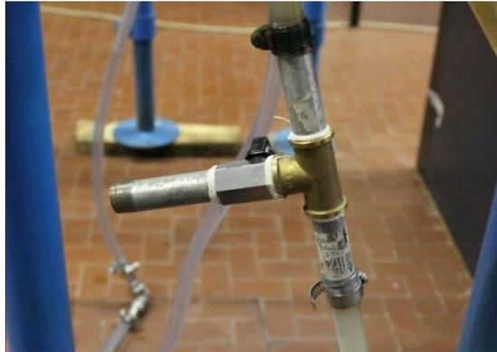
Figura 6.40 – Raccordo a T in ottone collegato al serbatoio di plastica ed equipaggiato con una valvola a sfera dotata di portagomma (Garofano, 2016)
