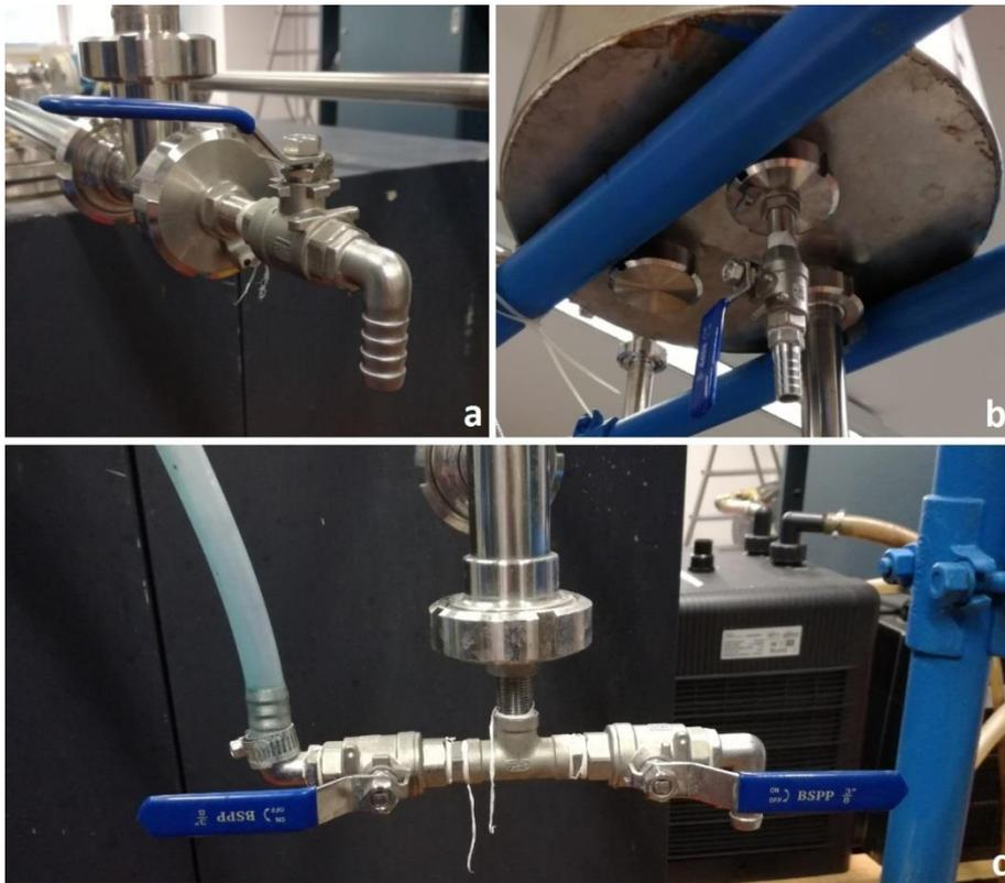
Figura 6.41 – Disposizione degli scarichi lungo l'impianto idraulico
