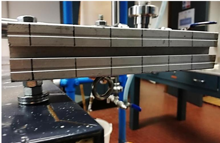
Figura 7.20 – Sistema di fissaggio del supporto al bancone (a sinistra) e vite per fissaggio del fonometro (al centro)
