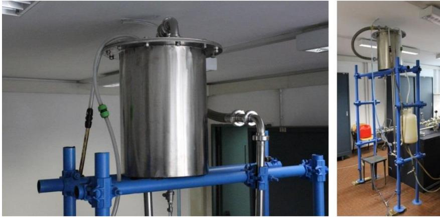
Figura 6.21 – Posizionamento del serbatoio di accumulo sull'impalcatura (Garofano, 2016)
