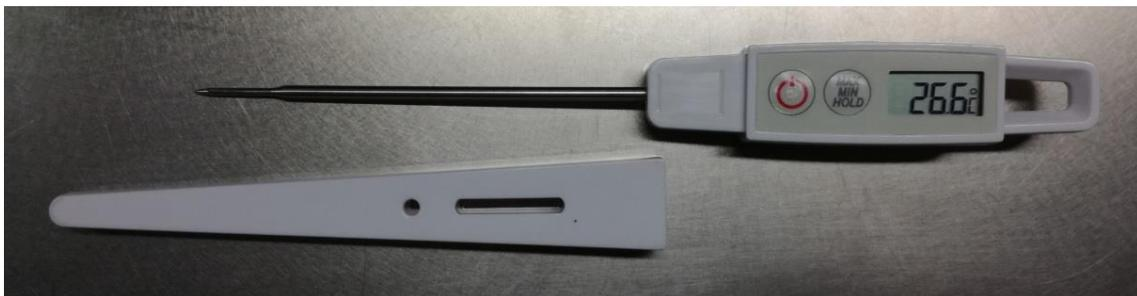
Figura 6.44 – Termometro a sonda *TFA DIGITAL Einstich-Termometer* con la fondina protettiva per il sensore.
