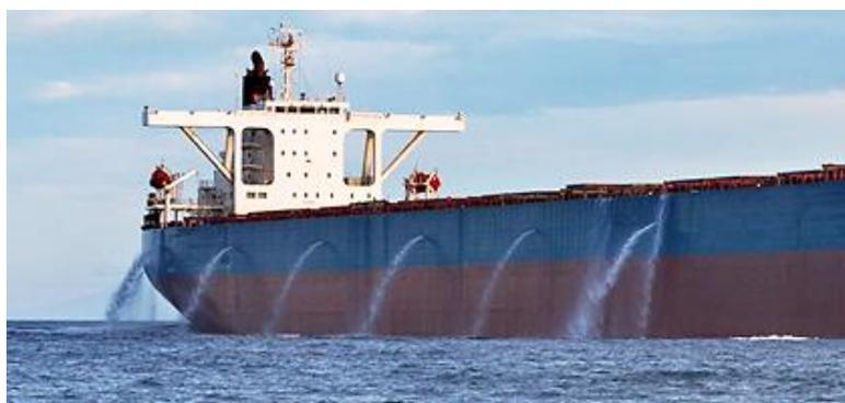
Figura 4.17 – Scarico dell'acqua di zavorra (Fonte: Cambiaso Risso Marine)
