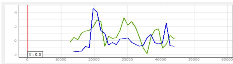
Figura 5.26 Profilo di velocità verticale (verde) e di intensità di precipitazione (blu) - linea 2.
