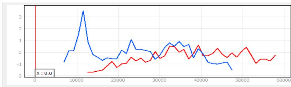
Figura 5.58 Profilo orografico (rosso) e di intensità di precipitazione (blu) - linea 8.
