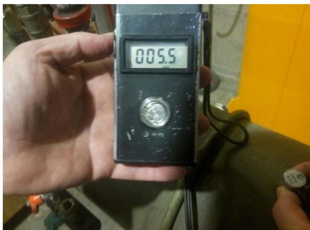
**Figura 4.6 - Verifica dello spessore della tubazione**
