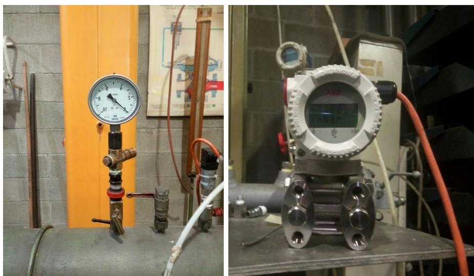
**Figura 4.5 – Tipi di misuratori di pressione utilizzati**
