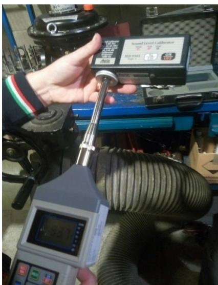
**Figura 4.11 - Procedura di calibrazione del fonometro**
