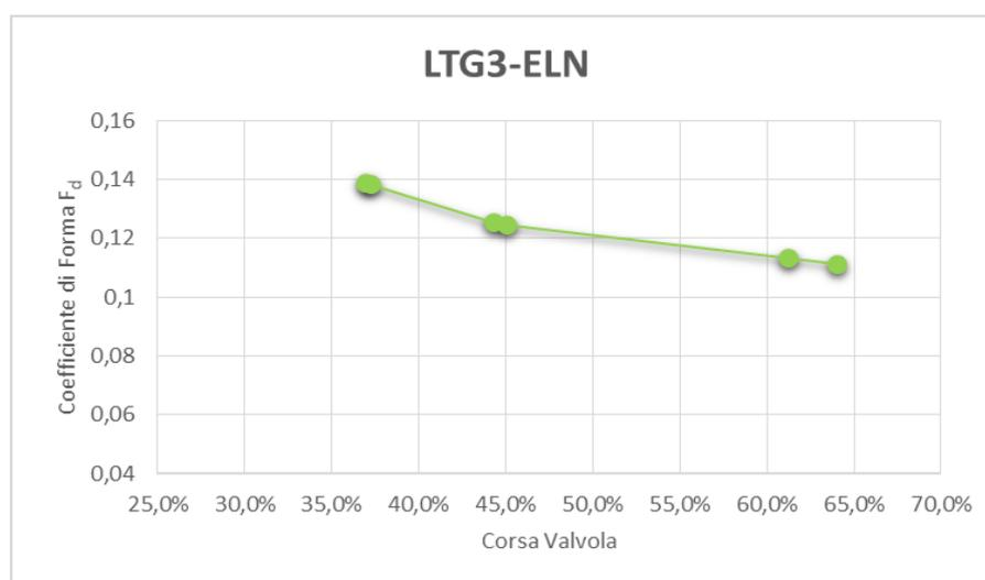
Figura 4.42 - Valori di  $F_d$  per il design LTG3-ELN
