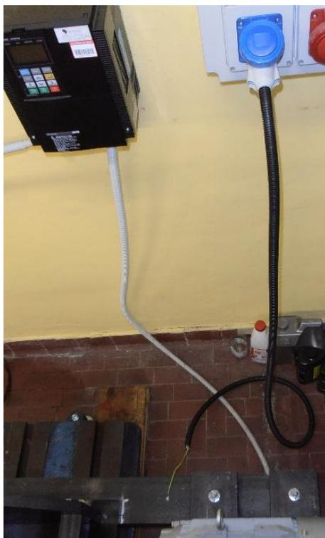
**Figura 4.14:** messa a terra del banco prova
