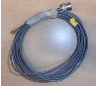
**Figura 2.4:** cavo del sensore di pressione
