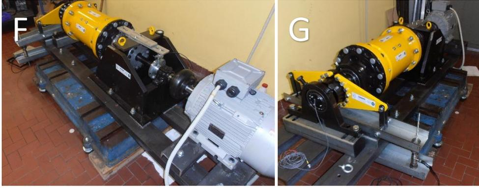
**Figura 3.7:** assemblaggio e calibrazione degli encoder
