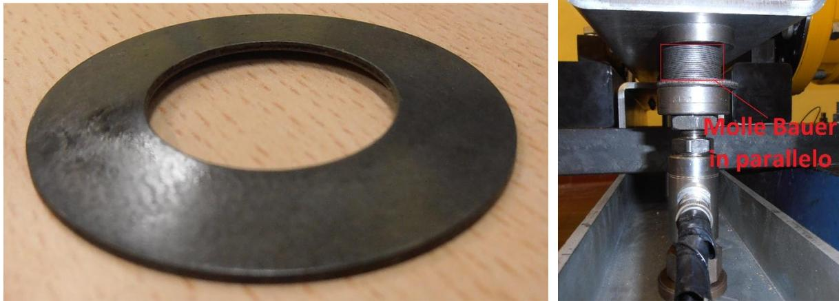
**Figura 1.9:** singola molla Bauer (a sinistra) e molle Bauer in parallelo (a destra)
