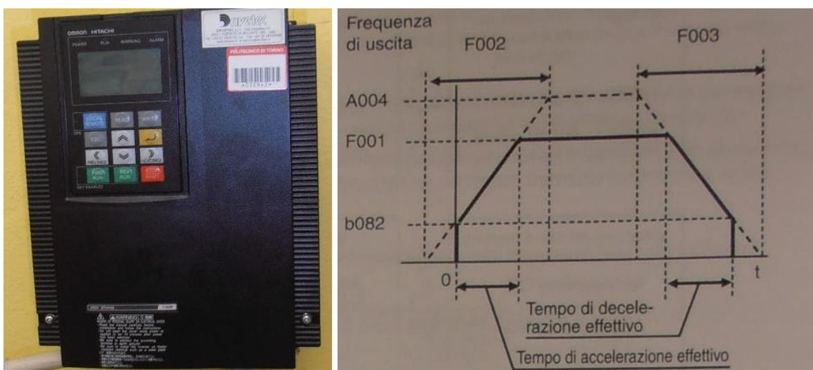
**Figura 4.1:** inverter (a sinistra) e grafico per la programmazione delle rampe (a destra)
