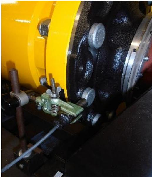
**Figura 4.2:** sensore di prossimità (contagiri)
