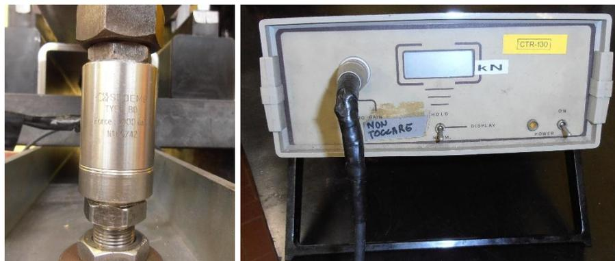
**Figura 4.3:** cella di carico (a sinistra) e suo alimentatore (a destra)
