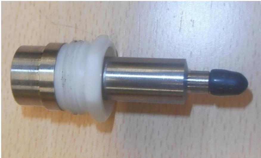
**Figura 2.1:** Sensore di pressione PCB 106B52
