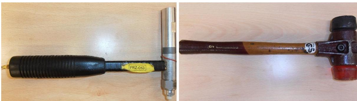
**Figura 4.6:** martello con cella di carico (a sinistra) e martello (a destra)
