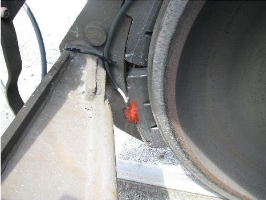
Figura 55 Installazione di una termoresistenza su una suola in ghisa
