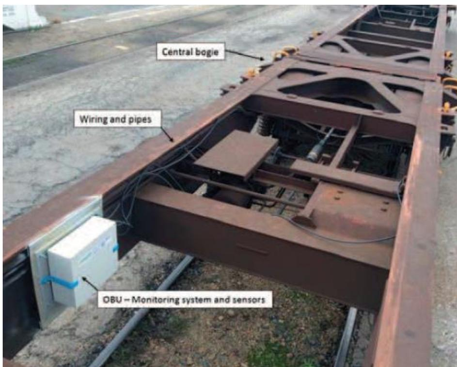
Figura 33. Installazione del sistema di monitoraggio su carrello centrale a sei assi
