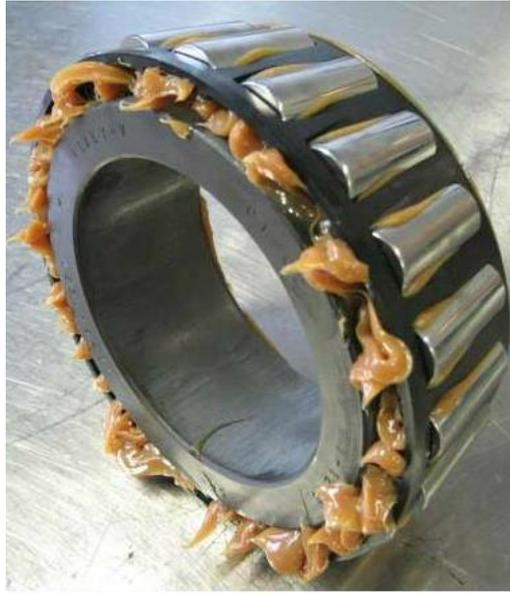
Figura 43. Esempio lubrificazione anello interno cuscinetto boccola
