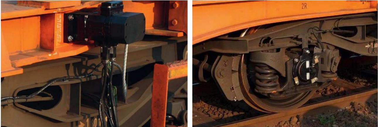
Figura 12. Cargo CBM, a sinistra unità on board installata, a destra tappo boccola sensorizzato
