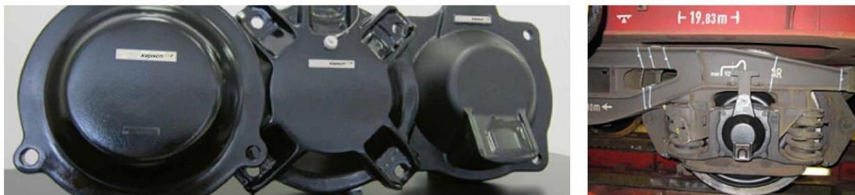
Figura 7. A sinistra differenti coperchi boccola per monitorare differenti carri, a destra il sistema installato
