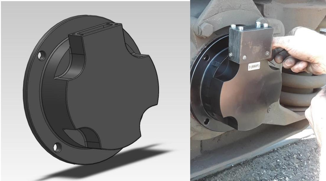
Figura 36. Tappo boccola sensorizzato progetto S.W.A.M Rail sinistra, installazione su carro a destra
