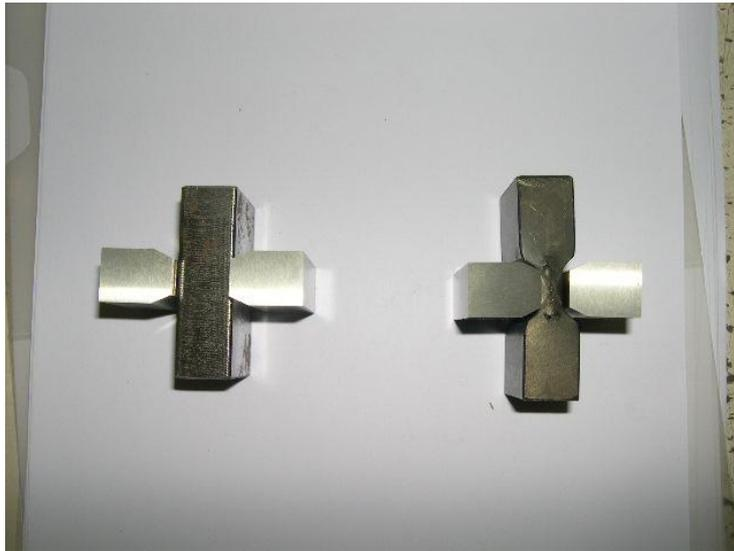
**Fig.8 – provino e incudini prima e dopo la deformazione**
