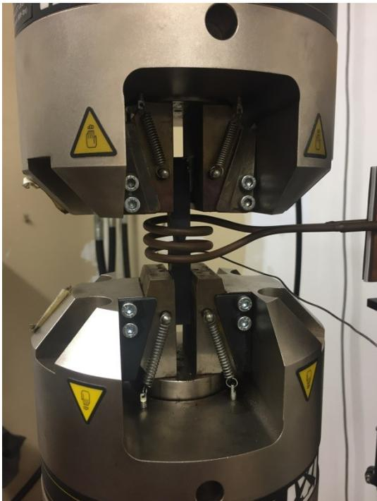
Figura 32: Montaggio provino su macchina Schenck per test ad alte T
