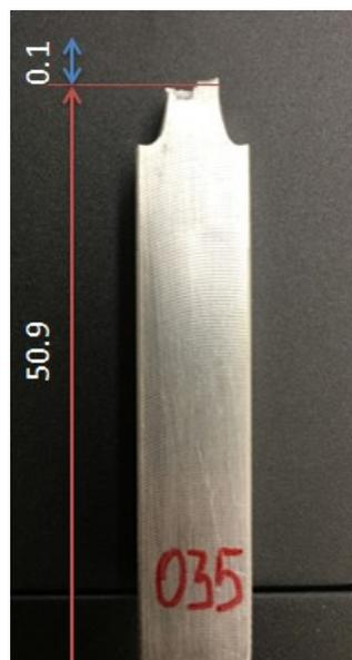
Figura 21: Altezza zona di rottura #035
