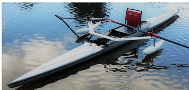
Figura 1.13: Imbarcazione per competizioni PR1, con galleggianti e schienale [24]
