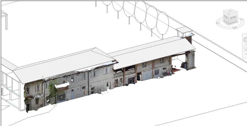
Visualizzazione della nuvola di punti del prospetto nord nel modello dello stato di fatto del convento e dei magazzini
