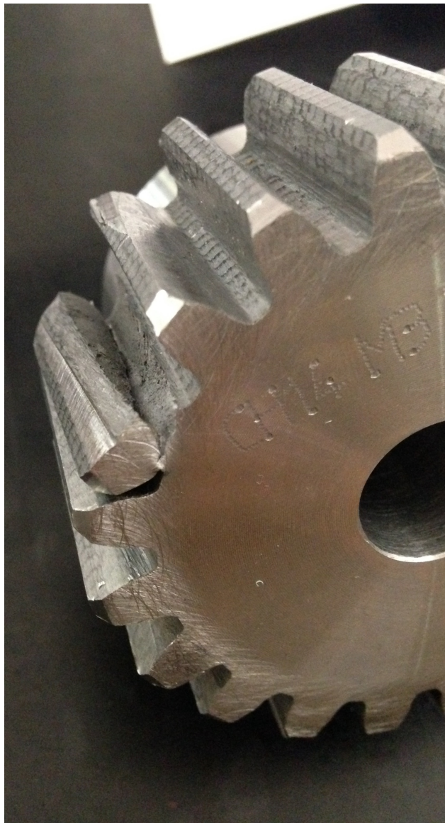
Fig. 3.4 Rottura del dente dopo la prova a fatica
