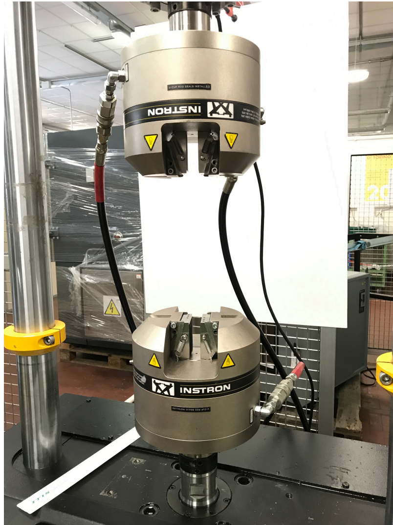
Fig. 2.21 Morse macchina INSTRON 8516
