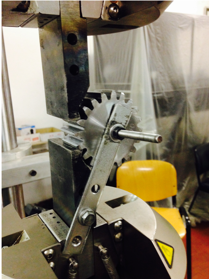
Fig. 2.23 Posizionamento con staffe
