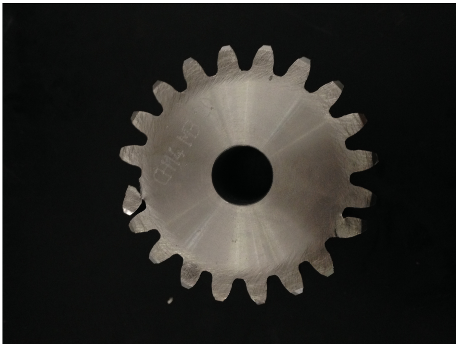
Fig. 3.3 Ruota dopo le prove a fatica
