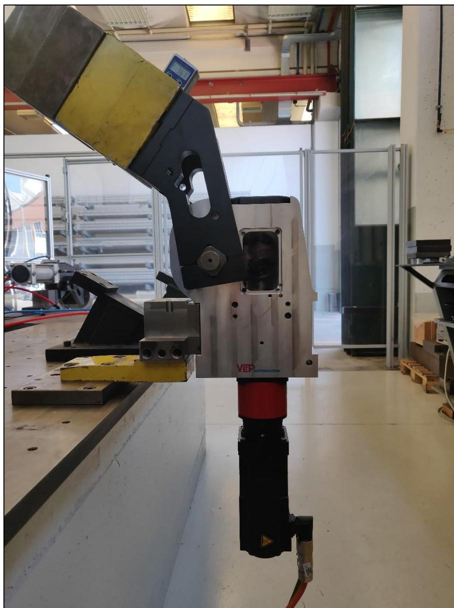
Figura 4.27 – Sistema di homing privo di arresto meccanico
