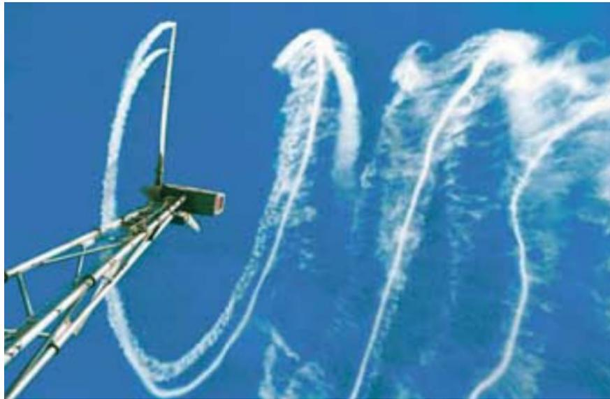
*Figura 10 -Turbina eolica dove si è aggiunto del fumo all'aria che vi passa attraverso. La scia si trascina chiaramente dietro la turbina (© 1998 www.WINDPOWER.org).*
