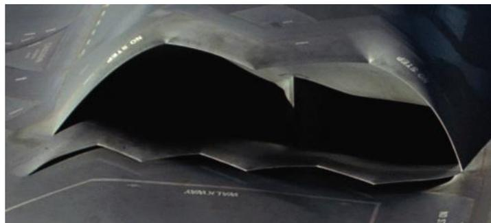
Fig. 8.3 Presa d'aria con profilo stealth improving
