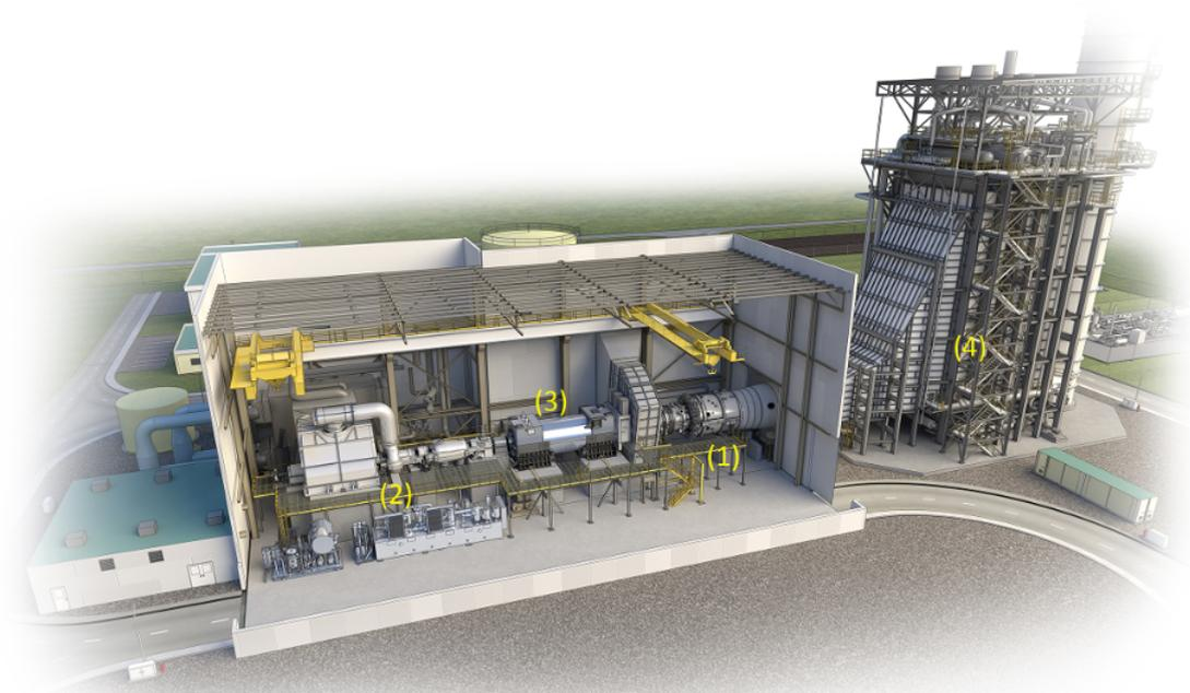
Figura 1.2: *Struttura di una centrale elettrica con ciclo combinato*
