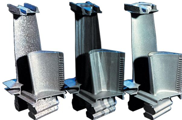
Figura 3.1: *Pale di turbina con ES, DS, SC.*
