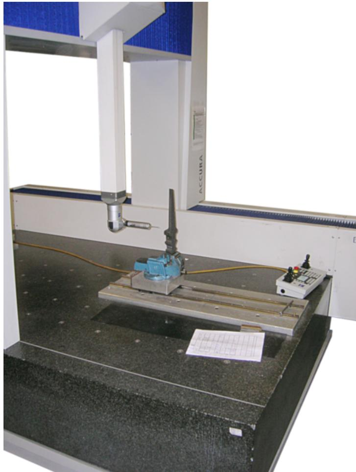
Figura 4.1: *Pala rotorica misurata da CMM*
