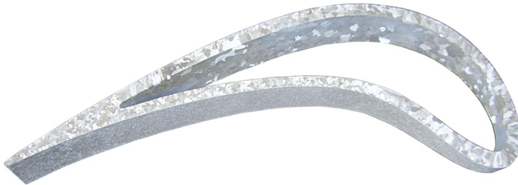
Figura 3.14: *Sezione di pala dopo attacco macro*
