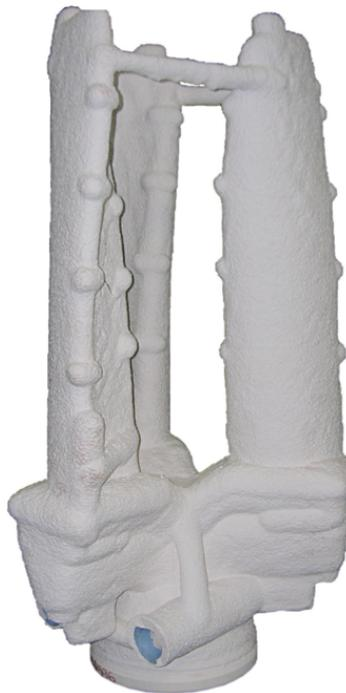
Figura 3.10: *Esempio di rivestimento completo di un grappolo*
