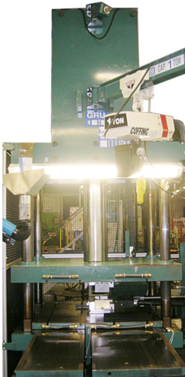
Figura 3.3: *Pressa idraulica con capacità di sollevamento pari a 1000 kg*
