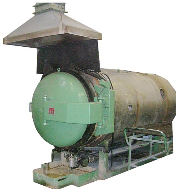
Figura 3.11: Autoclave con relativo sistema di aspirazione dei vapori
