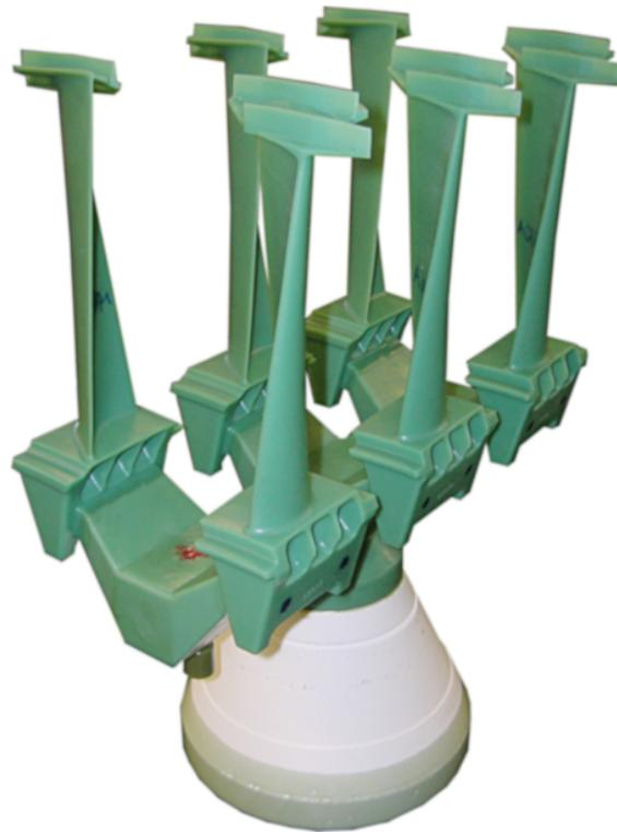
Figura 3.8: *Grappolo composto da sei palette, in cui si distingue la campanella in basso e il sistema di alimentazione in cera*
