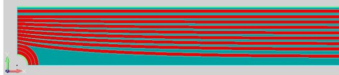
Figura 5.24: Geometria di rinforzo per configurazione a tre rinforzi circolari
