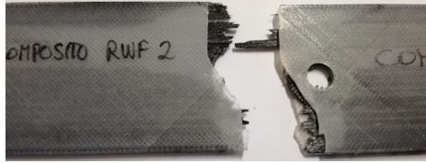
Figura 6.14: Zona di rottura per piastre in composito rinforzato
