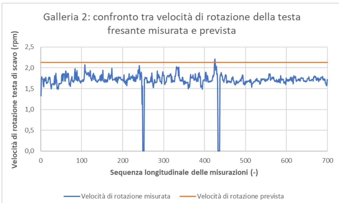
Grafico 7-9. Confronto tra velocità di rotazione della testa di scavo prevista e velocità di rotazione misurata durante la realizzazione di Galleria 2
