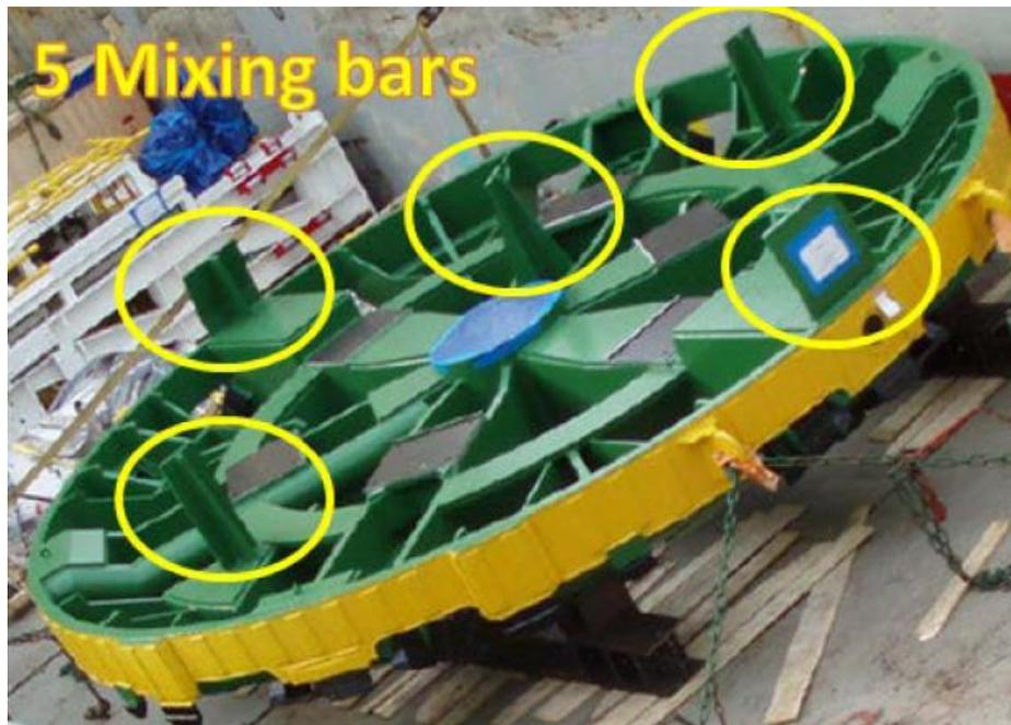
*Figura 3-9. Barre miscelatrici montate sul retro della testa fresante [13]*
