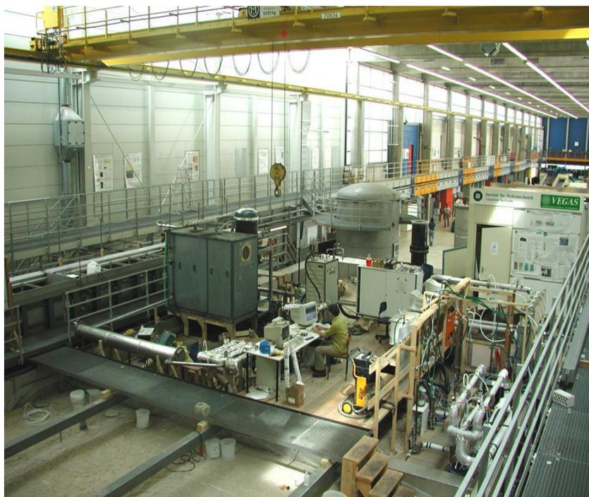
Figura 5.1 – Large Scale Container (nell'angolo in basso a sinistra) e la stazione di controllo nel centro di ricerca VEGAS a Stuttgart, in Germania (Miyajima 2013).
