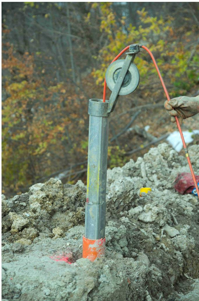
Figura 1.1: Tubo inclinometrico
