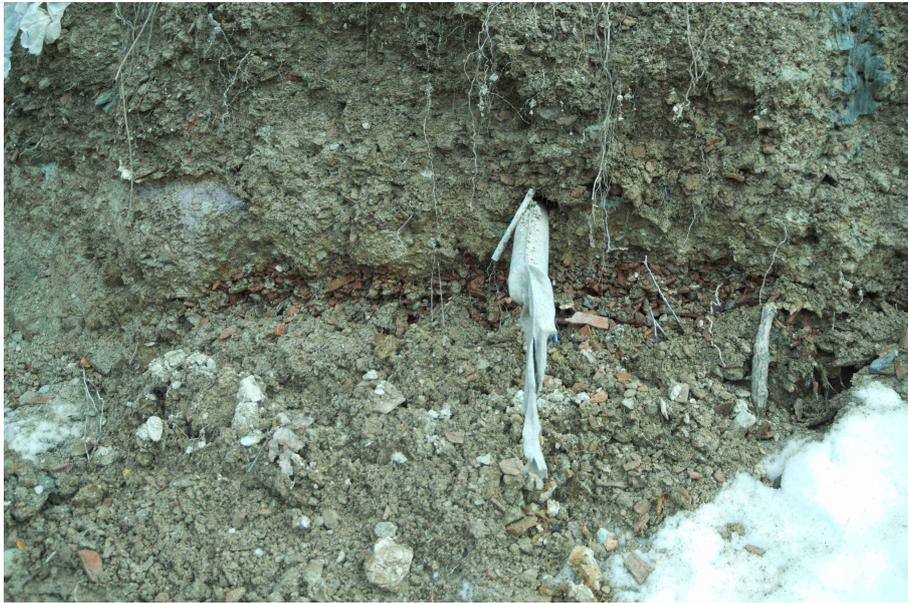
Figura 6.1: Presenza di detriti nello strato di copertura - foto del 15.11.2017
