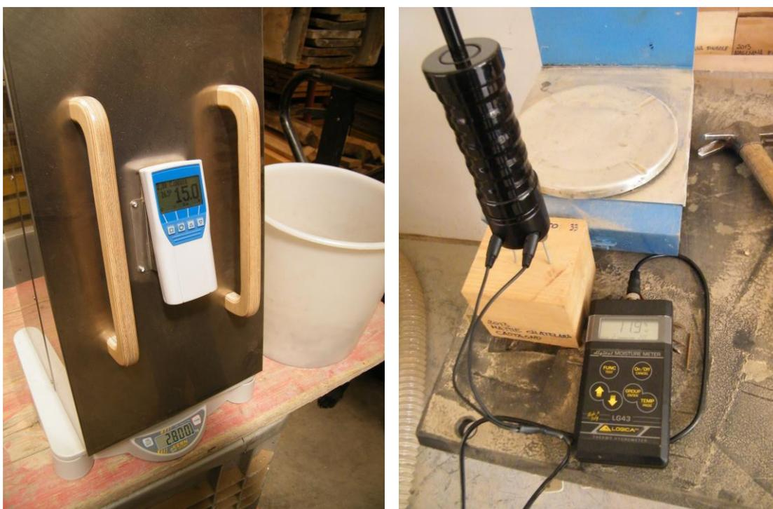
*Figura 32: Igrometro per biomasse e ad infissione durante la misurazione (Fonte: elaborazione personale)*
