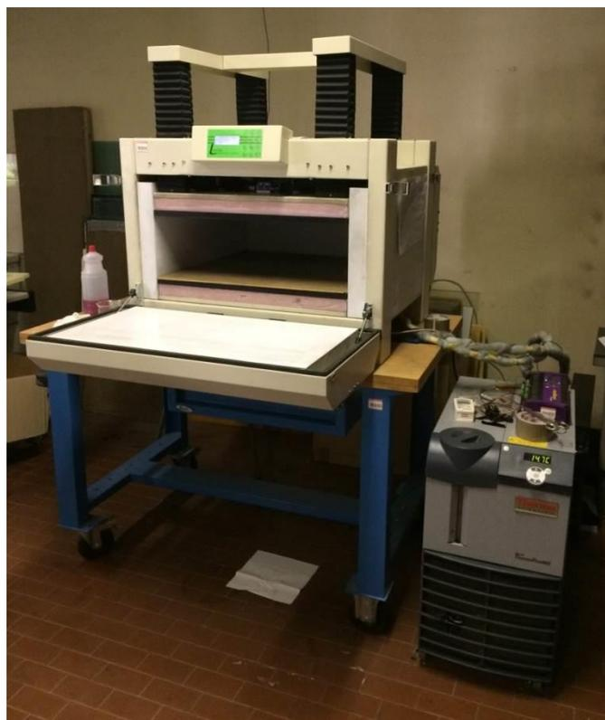
*Figura 26: Piastra calda con anello di guardia preparata per le prove (Fonte: elaborazione personale)*
