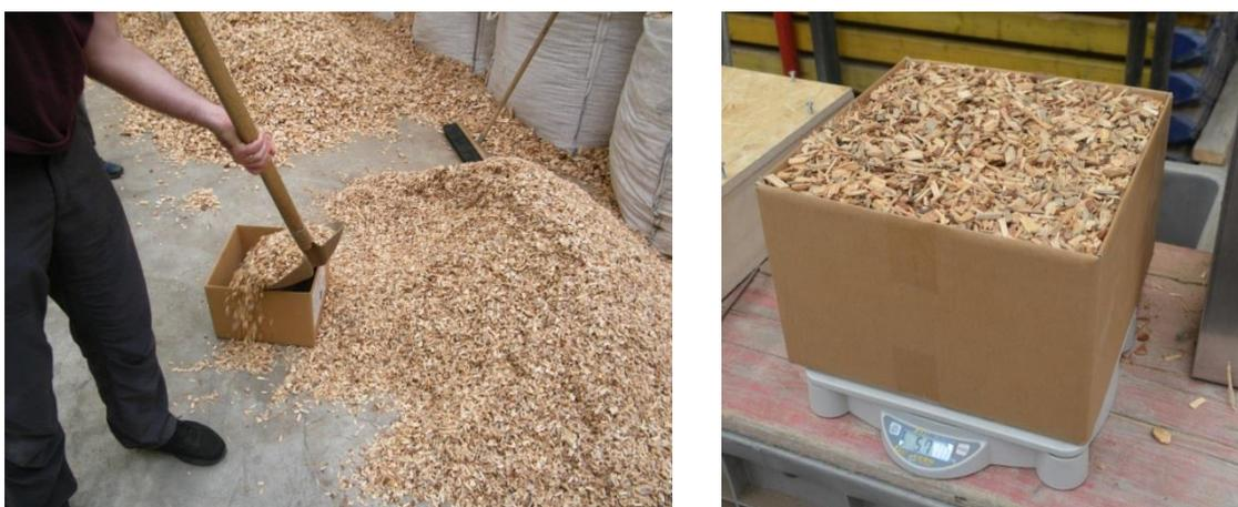
Figura 38: Procedimento di analisi della densità dei mix-design. La miscela viene inserita all'interno del volume di riferimento e pesata per permettere la ripercorribilità del procedimento (Fonte: elaborazione personale)
