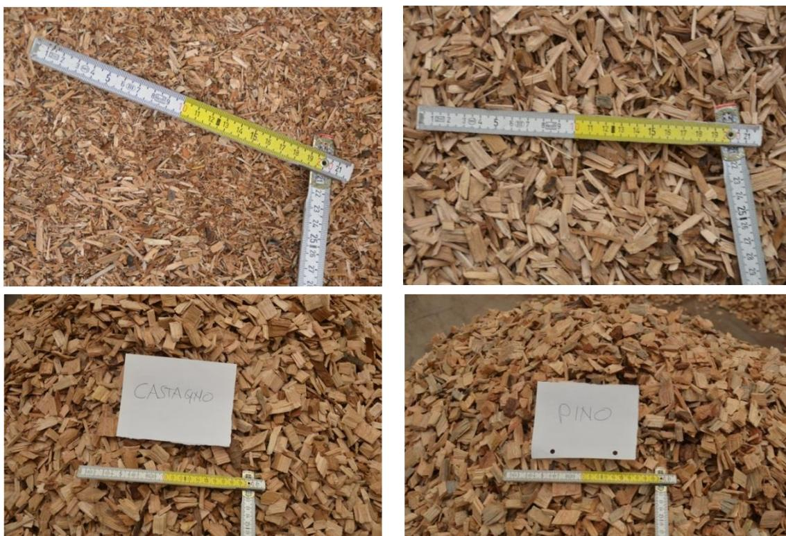
Figura 34: Granulometrie del materiale. Dall'alto la più fine, media pezzatura e le pezzature maggiori (Fonte: elaborazione personale)
