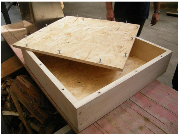
Figura 22: Cassero di prova ( Fonte: elaborazione personale )
