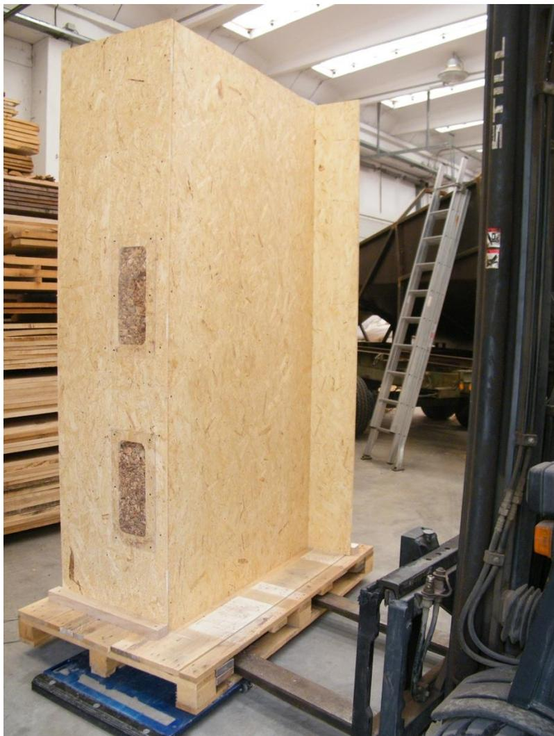
*Figura 25: Parete di prova dopo l'immissione del materiale (Fonte: elaborazione personale)*
