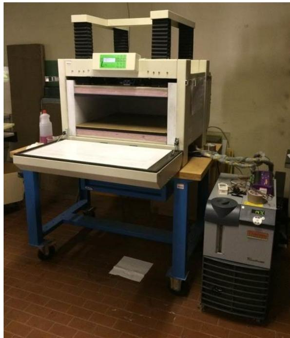
Figura 41: Piastra calda utilizzata per le prove in laboratorio (fonte: Elaborazione personale)
