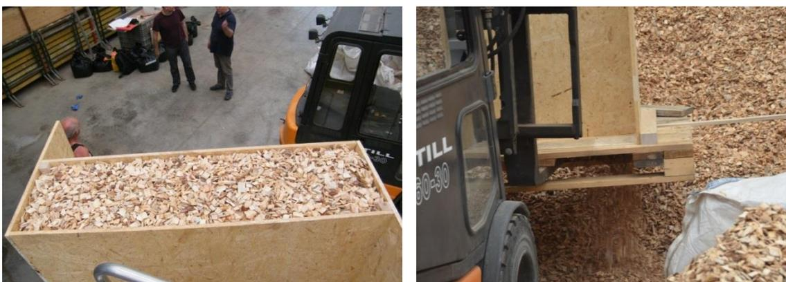
Figure 36: Procedura di riempimento del cassone di muratura. Dopo il riempimento il cassone viene svuotato dalla parte inferiore (Fonte: elaborazione personale)
