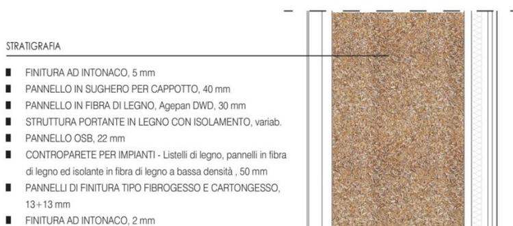
*Figura 51: Stratigrafia della muratura esterna in esame (Fonte: elaborazione personale)*
