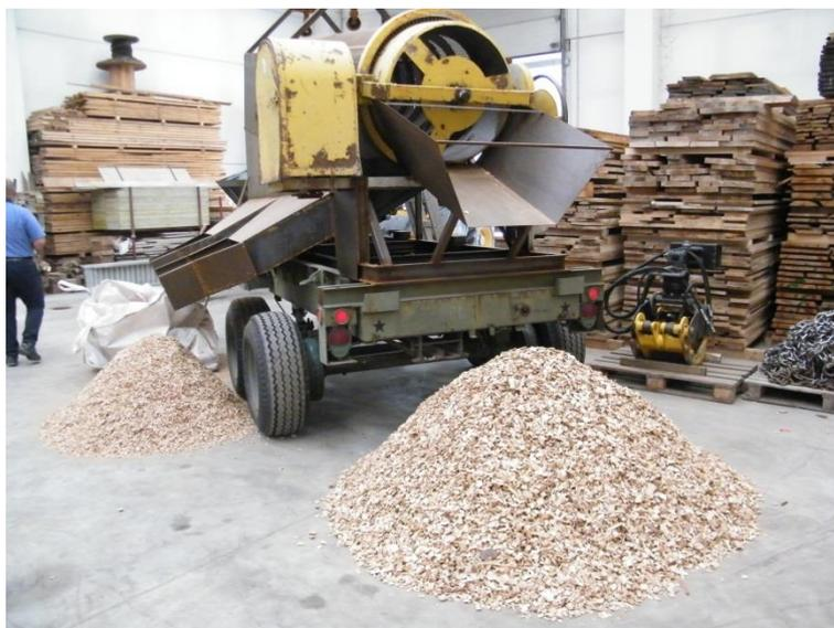
*Figura 23: Prodotti di lavorazione proveniente da una cippatrice artigianale in azienda (Fonte: elaborazione personale )*
