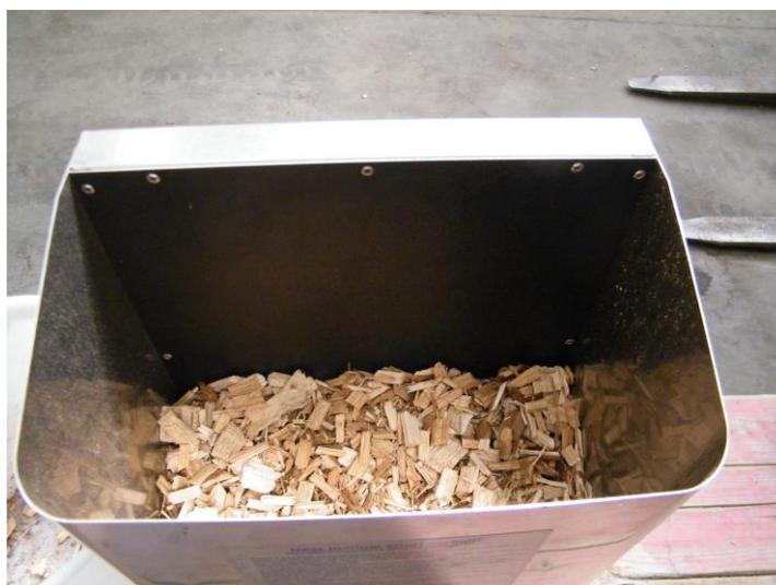
*Figura 29: Cippato all'interno dell'igrometro per la misurazione (Fonte: elaborazione personale)*
