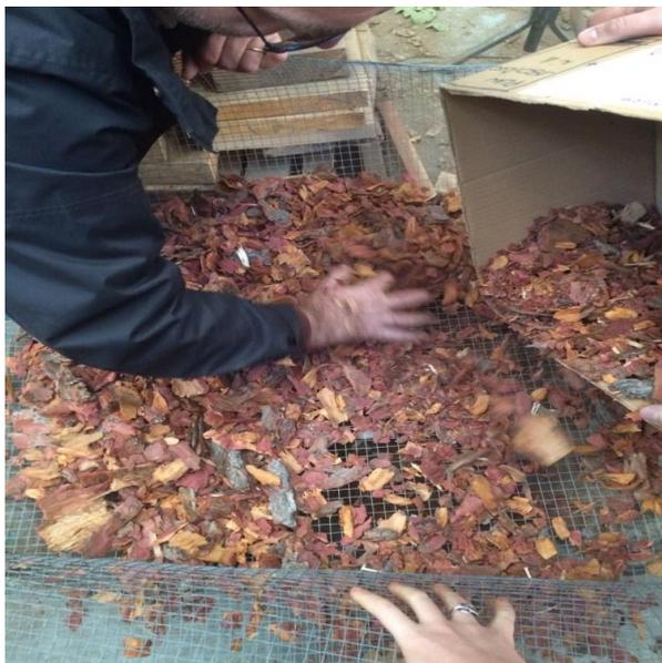
Figura 41 : Setacciatura della corteccia (Fonte: elaborazione personale)
