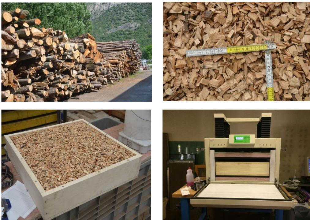
*Figura 19: Alcuni passaggi effettuati durante l'analisi del materiale. Dall'alto verso destra : stoccaggio della materia prima, caratterizzazione del materiale, preparazione per le prove e analisi in piastra calda (Fonte: elaborazione personale)*
