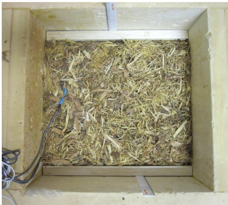
*Figura 14: Cippato di corteccia in fase di analisi (Fonte: Pasztory Z., Ronyecz I., The thermal Insulation Capacity of Tree Bark. University of West Hungary.)*
