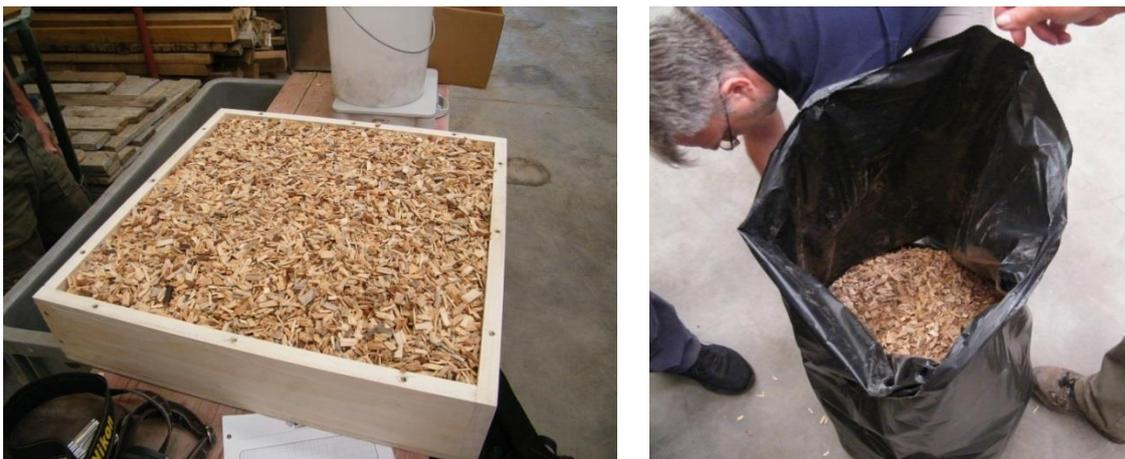
*Figura 39: Procedimento di analisi della densità dei mix-design . Dopo la scelta della miscela, la sua pesatura e l'inserimento nel cassero, il cippato viene inserito in sacchi di polietilene sigillati per il trasporto in laboratorio (Fonte: elaborazione personale).*
