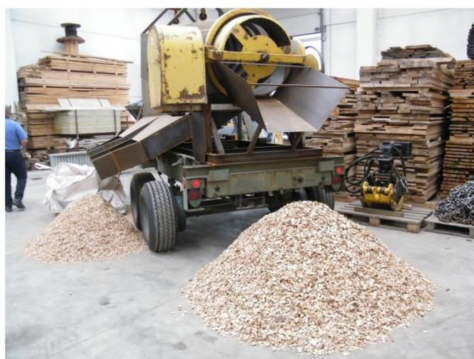
*Figura 31: Fori di uscita del cippato dalla macchina (Fonte: elaborazione personale)*
