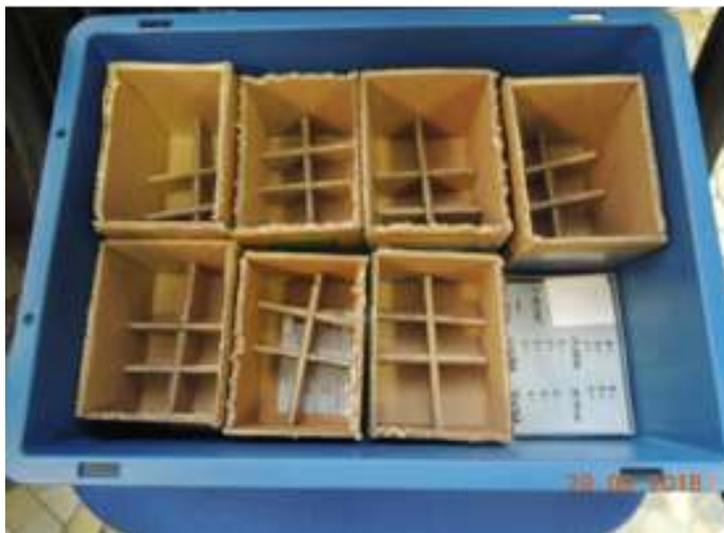
*Figura 30 - Cassetta per l'emissione di componenti flessibile. I componenti vengono contenuti in delle scatole a due livelli. È adeguata sia per la minuteria che per i pezzi più grandi*
