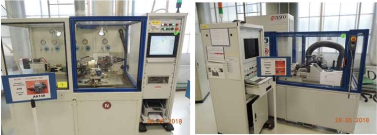
*Figura 35 - Banchi di collaudo automatici. Da sinistra a destra, per il collaudo di: PVM e SJ Cessna*
