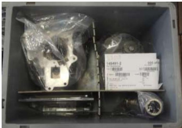
*Figura 26 - Cassetta contenitore del pezzo smontato suddivisa tramite separatori in plastica*
