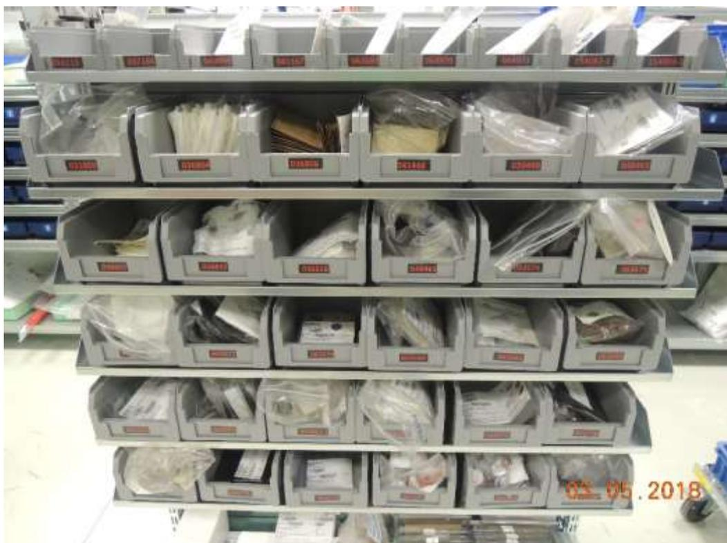
*Figura 25 -1 Carrello dedicato per il prelievo di componenti emessi per ogni part list*
