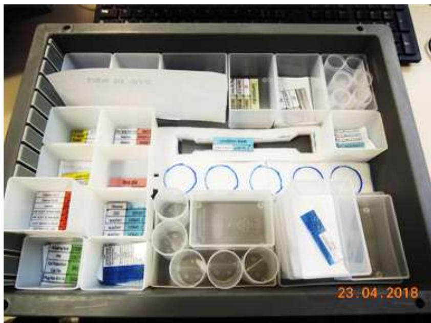
*Figura 29 - Cassetta per l'emissione di componenti flessibile. I componenti vengono contenuti in delle piccole scatole a seconda il sottogruppo a cui appartengono*
