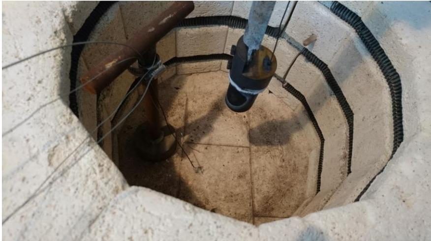
Figura 4.15 - Termocoppie inserite nel forno per valutare le disuniformità termiche
