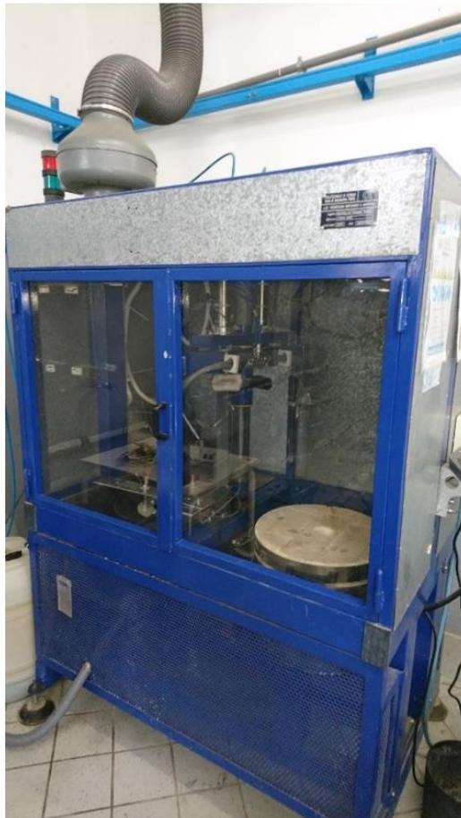
Figura 4.8 - Ciclatore utilizzato per le prove di ciclaggio termico
