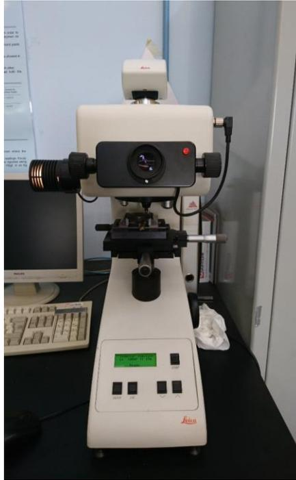
Figura 4.35 - Microdurometro LEICA VMHT
