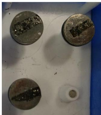
Figura 4.42 - Esempio di 3 campioni di polvere depositati sui piattelli del SEM
