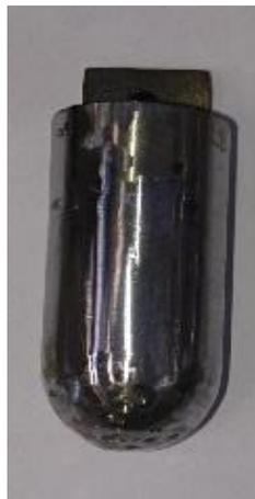
Figura 4.12 - Campione usato per la taratura dei cicli termici
