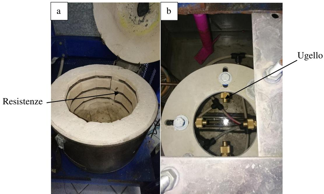
Figura 4.9 - Zone di a) riscaldamento e b) raffreddamento del ciclatore termico
