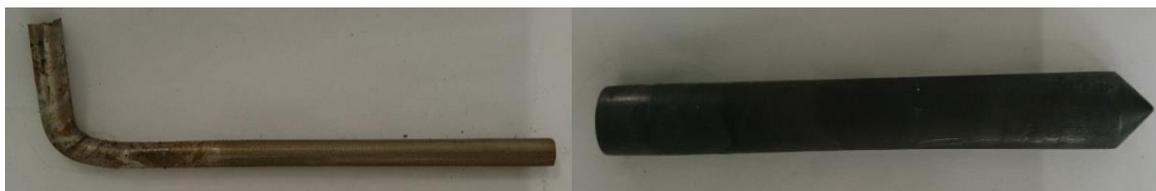
Figura 4.20 - Catodo in a) acciaio inox e b) grafite
