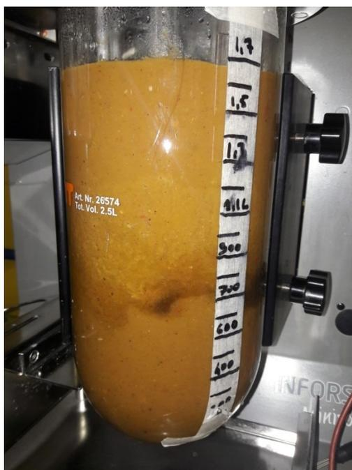
Figura 6.2 Buona miscelazione del sistema, PBT-45° a 120 rpm
