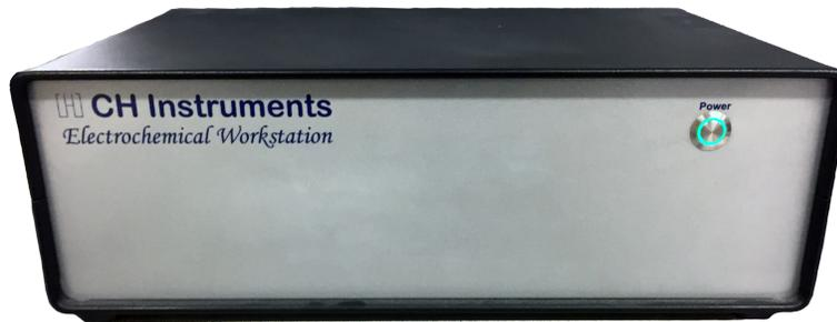
Figura 3.11: Potenziostato CH Instruments 1660D.
