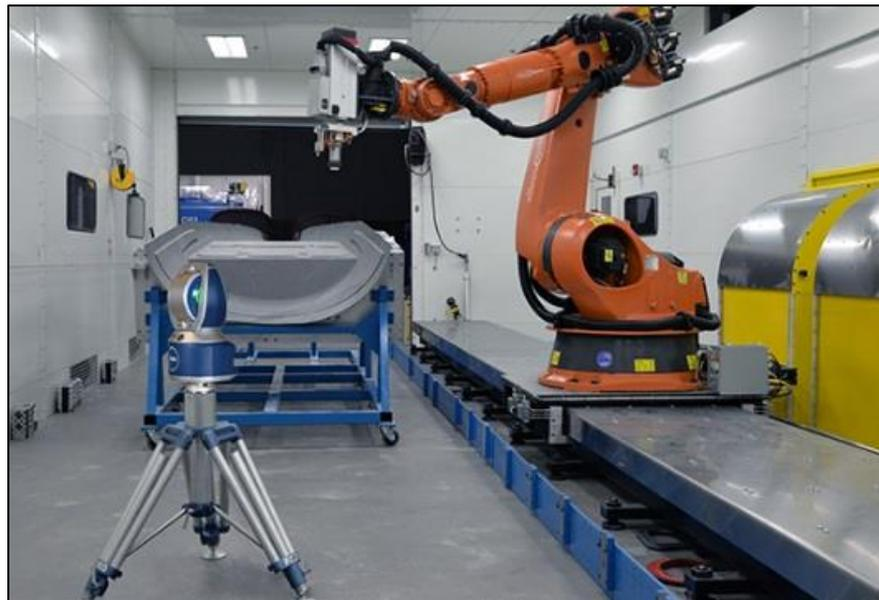
**Figura 1.17: Robot di rilevamento metrologico (FARO, 200)**
