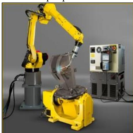
Figura 1.11: Robot saldatura ad arco (FANUC, 2000)
