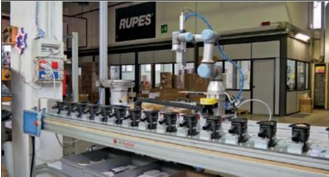
**Figura 2.11: UR3 nell'applicazione attiva in Rupes (Automazione-plus, 2017)**
