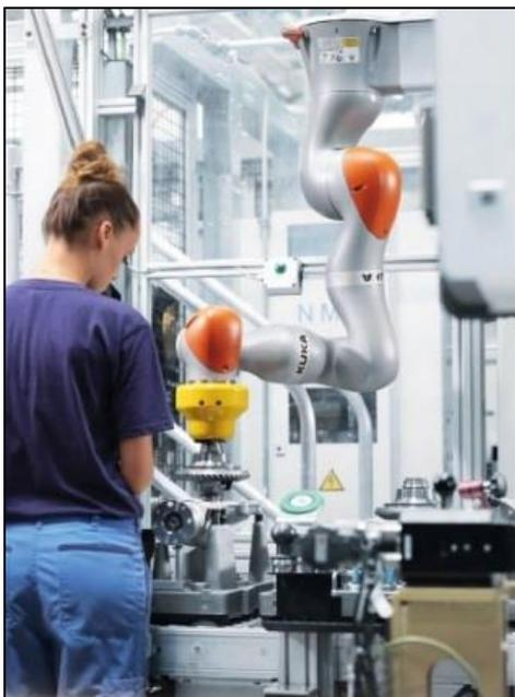
Figura 2.23: Assemblaggio asse anteriore di trasmissione (KUKA, 2017)
