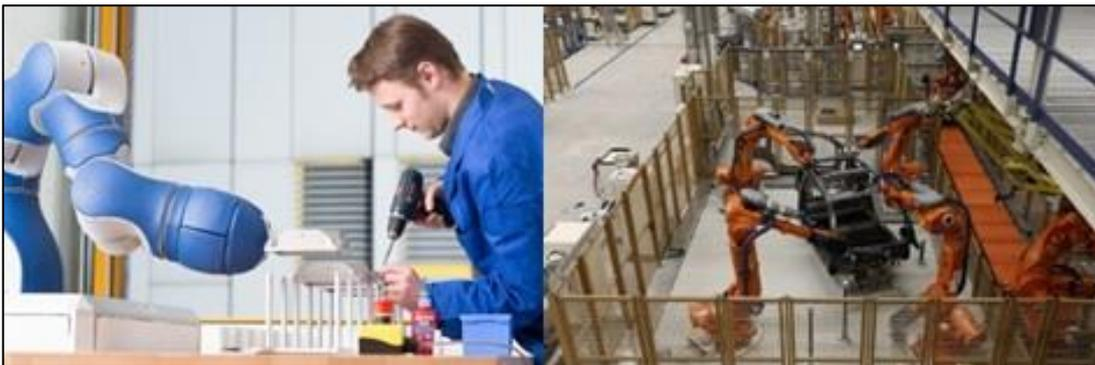
Figura 1.20: Robot collaborativi vs Robot industriali (Fonte: FPROBOTICS, 2017)
