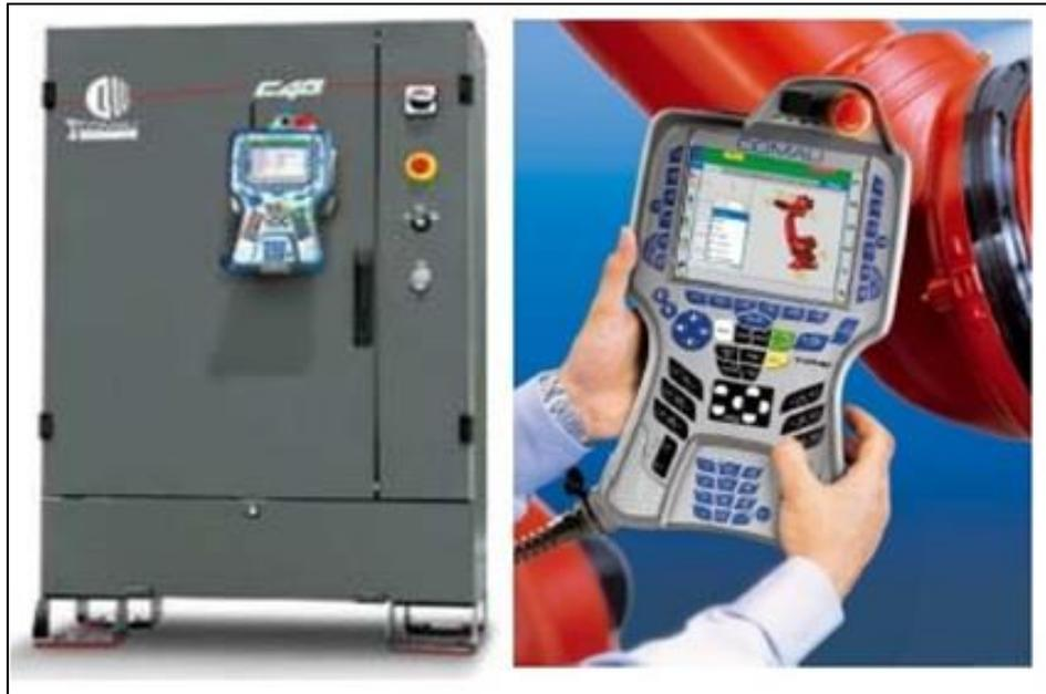
Figura 1.4: L'unità elettronica di programmazione e controllo (Rocco, 2017)
