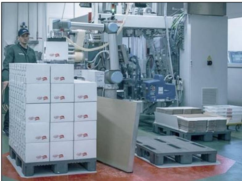
**Figura 2.15: Pallettizzazione in Nortura (Universal Robots, 2017)**
