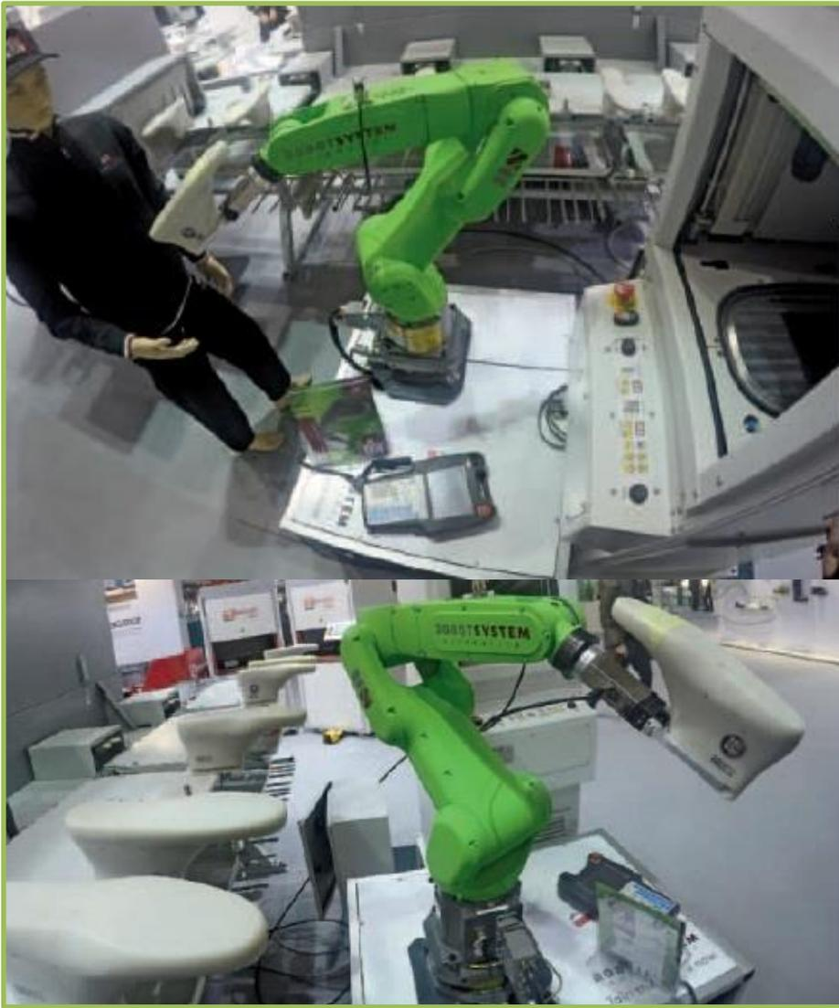
Figura 2.8: Cobot FANUC CR-7iA nel settore calzaturiero (Fanuc, 2017)
