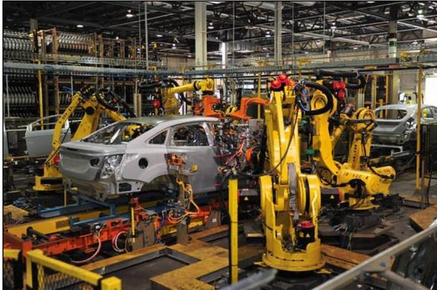
Figura 1.16: Robot di assemblaggio (ANSA, 2011)
