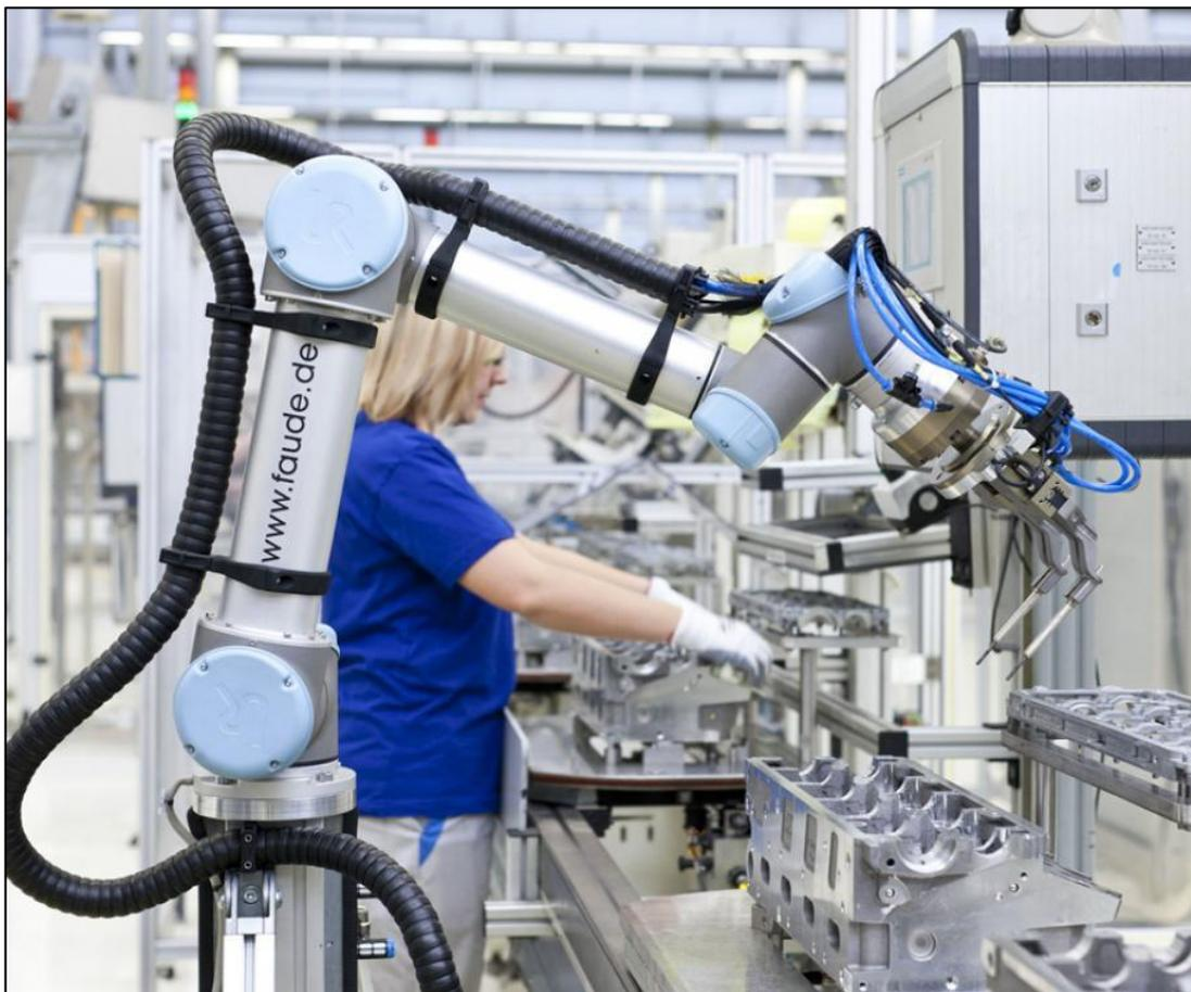
**Figura 2.13: UR5 nello stabilimento Volkswagen (Automazione-plus, 2013)**
