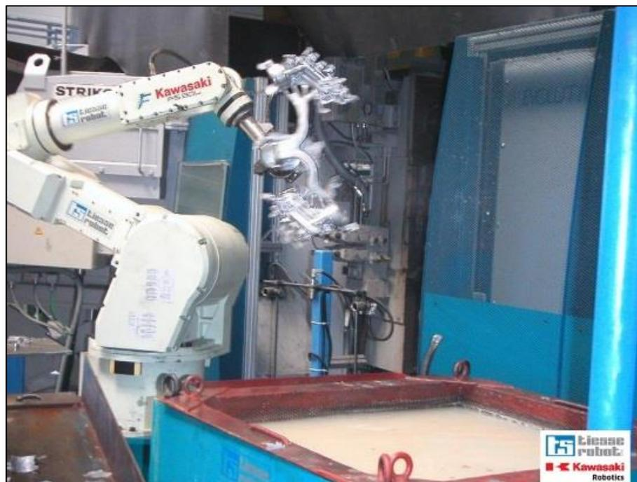
**Figura 1.13: Robot di pressofusione (TIESSEROBOT, 2000 )**
