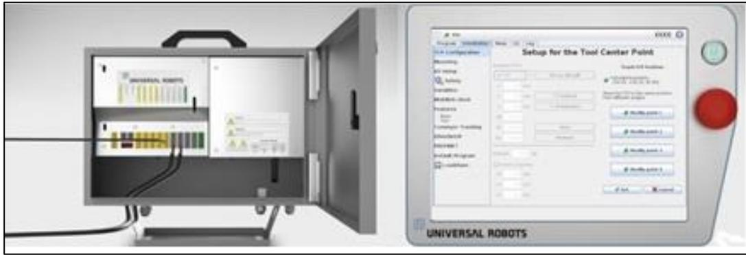
Figura 1.21: Unità di controllo e teach pendant (Fonte: Universal Robots, 2017)
