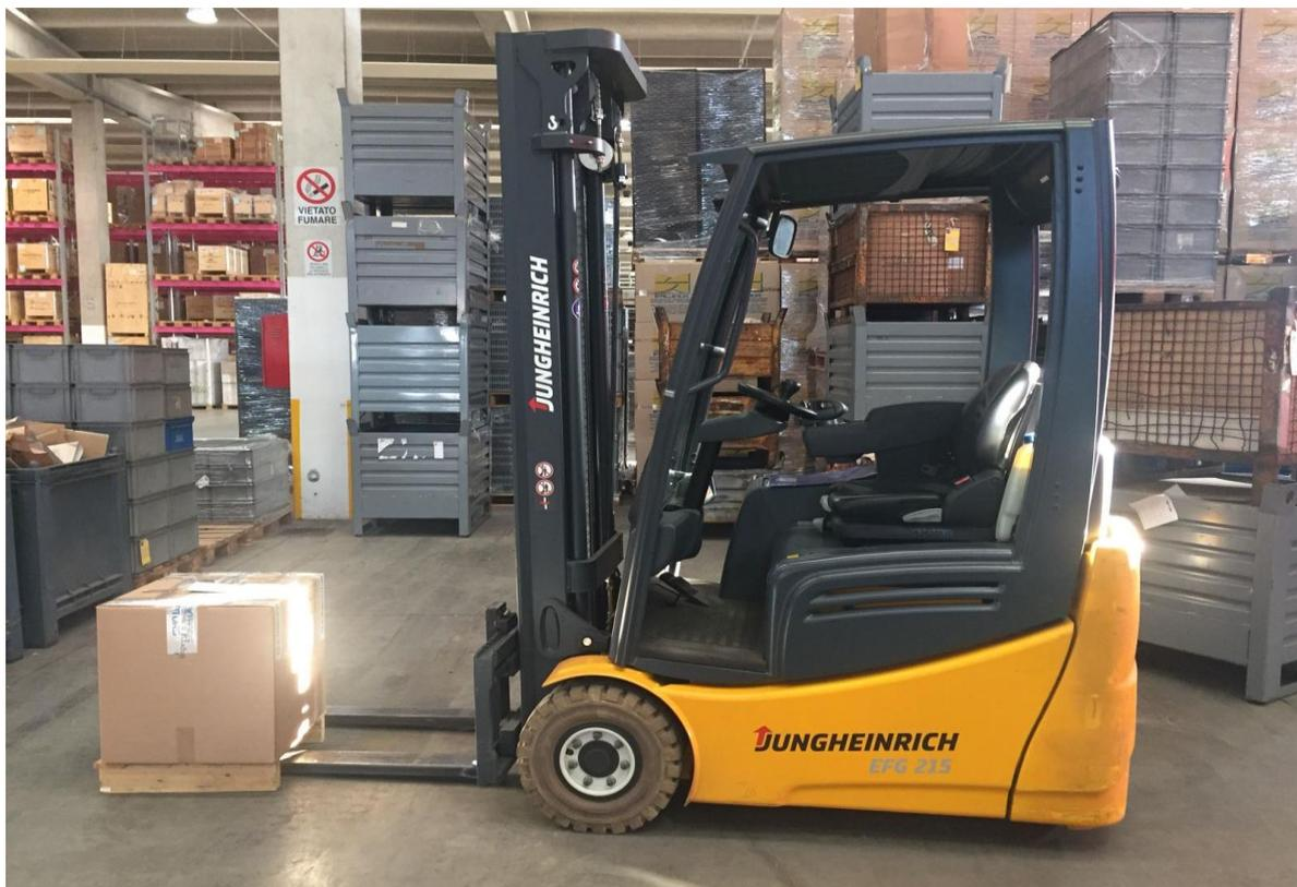
*Figura 5.3: Carrello con forche a sbalzo utilizzato nella fase di approvvigionamento.
