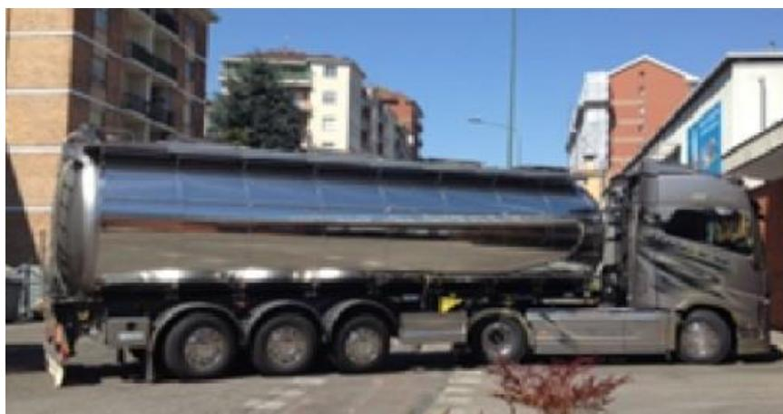
**Figura 3.8 Cisterna per il trasporto di latte crudo**
