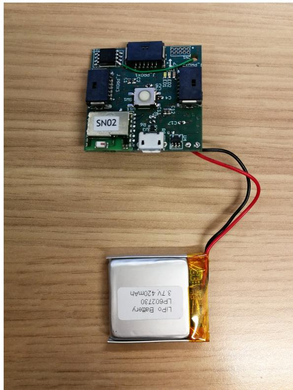
**Figura 1.1:** Sistema SWING: circuiteria lato superiore.
