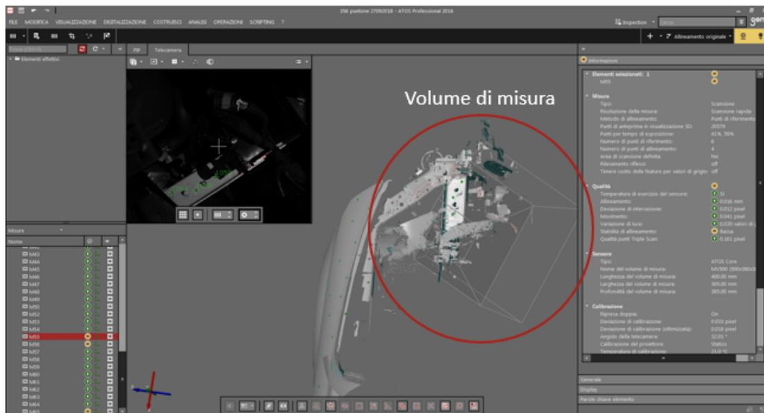
Figura 2.12: Esempio di scansione del puntone di una vettura reale.
