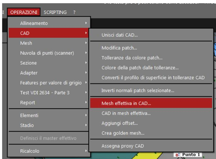
Figura 2.7: Sequenza di comandi per trasformare la mesh in CAD e viceversa.
