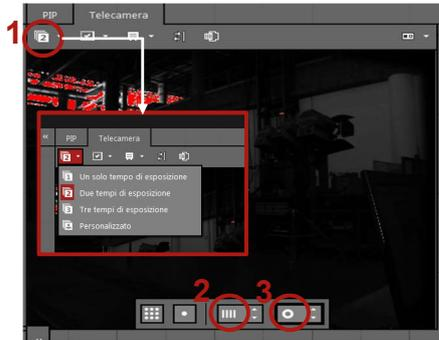
1. **Tempo di esposizione:** con un solo tempo, lo scanner effettua una scansione unica di durata regolabile dall'utente, altrimenti ne effettua due o tre. È possibile impostare i tempi di esposizione in modo manuale.
