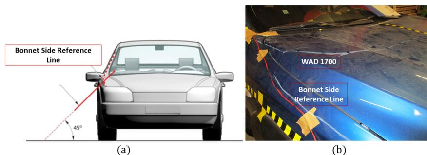
Figura 6.11: Schema per la tracciatura della Bonnet Side Reference Line (a) e tracciatura reale sulla vettura con tratteggi bianchi (b).
