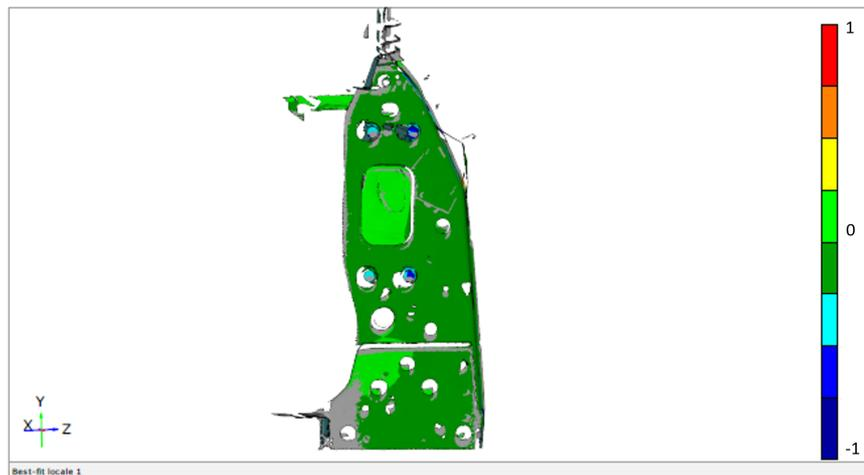
Figura 4.24: Mappa cromatica delle deviazioni lungo l'asse x provocate dall'urto sulla parte anteriore della flangia del puntone della prima linea di carico e sul *vertical link*.
