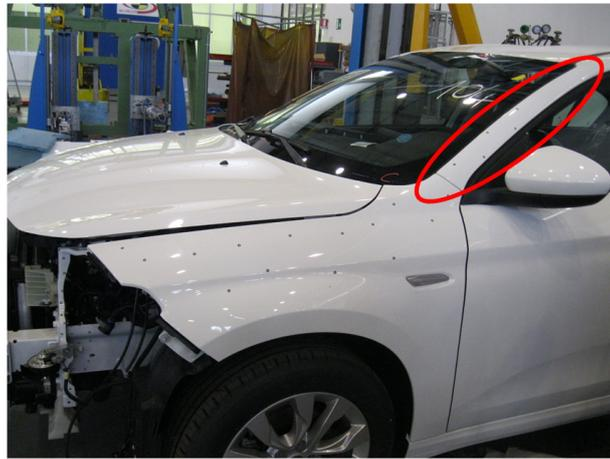
Figura 4.2: Posizionamento dei marker sul primo veicolo (modello 1) a partire dal montante "A", cerchiato in rosso.
