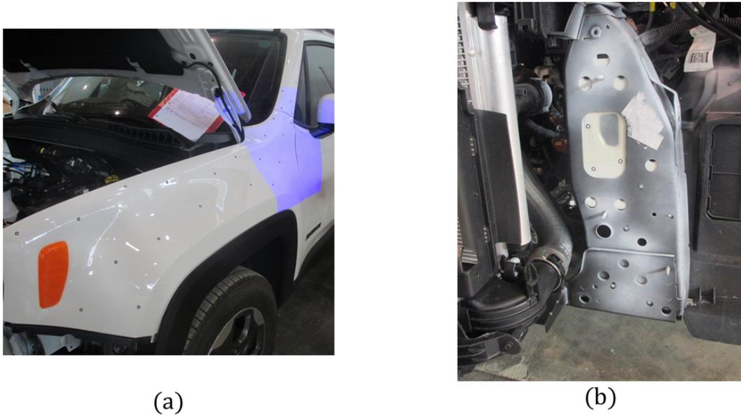
Figura 4.19: Posizionamento dei marker adesivi dal montante "A", passando sul parafrango (a) e arrivando alla flangia frontale del puntone della prima e della terza linea di carico (b).
