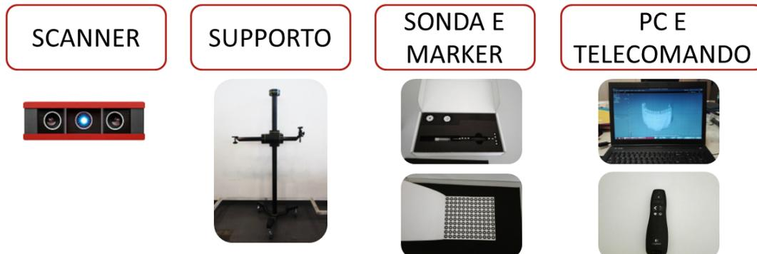
Figura 2.4: Componenti in dotazione con lo scanner *ATOS Core 500*.
