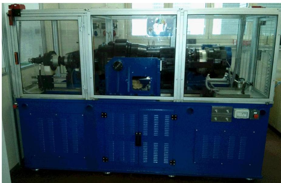
Figura 2.1 – Banco di prova per accoppiamenti scanalati
