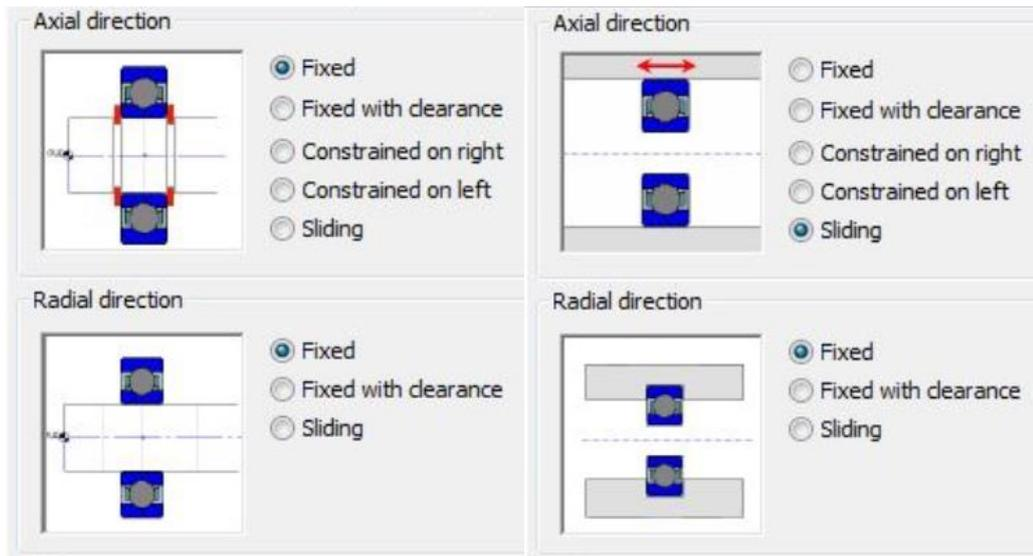
Figura 3.38 – Montaggio del cuscinetto con blocco radialmente ma libero assialmente (cuscinetti A1-B1)
