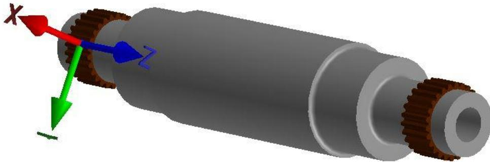
Figura 3.55 – Modello CAD dell'albero centrale
