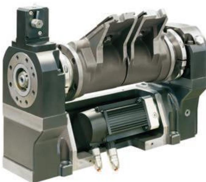
Figura 17 - Meccanismo d'inversione con neckring
