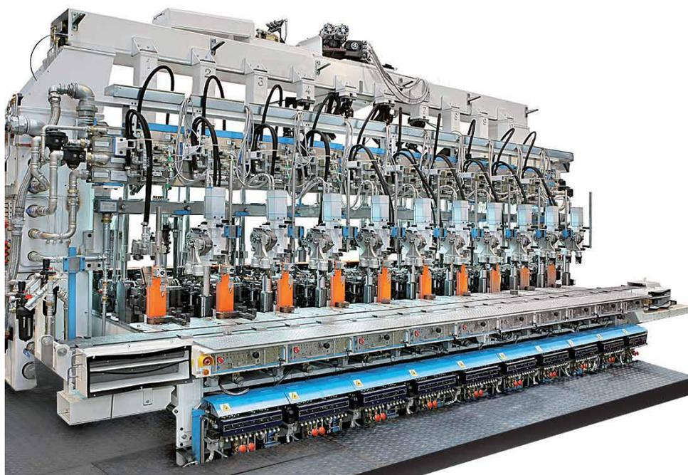
**Figura 7 - Macchina formatrice IS**
