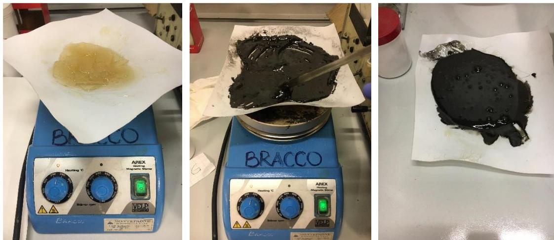
Figura 3.18 Preparazione dell'adesivo modificato
