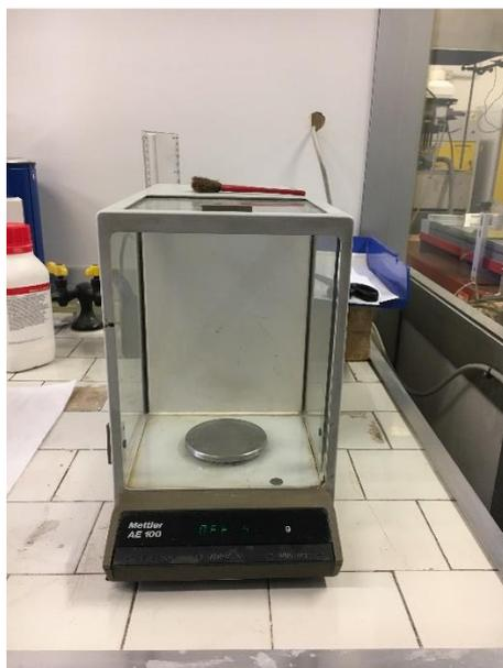
Figura 3.17 Bilancia analitica di precisione
