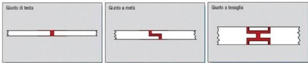
Figura 1.6 Configurazioni svantaggiose: giunti di testa, giunti a metà, giunti a tenaglia [2]
