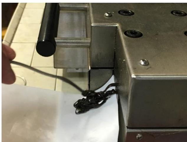
Figura 3.21 Recupero del materiale microestruso
