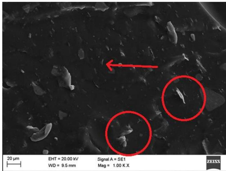
Figura 4.10 Nanoplatelets di grafene al SEM
