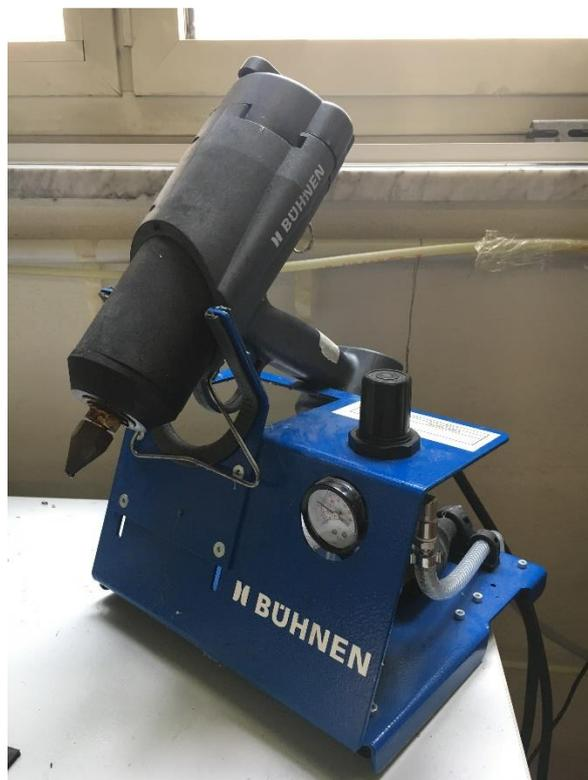
Figura 3.23 Pistola per applicazione di adesivi hot-melt
