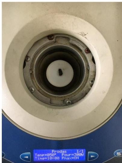
Figura 3.13 Posizionamento centrale del campione
