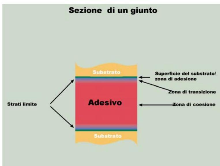
Figura 1.9 Sezione di un giunto [8]
