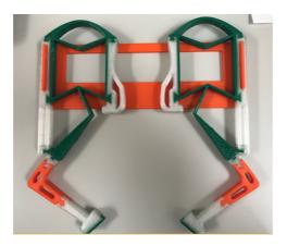
Figura 5.18: Prototipo completo modulare stampato
