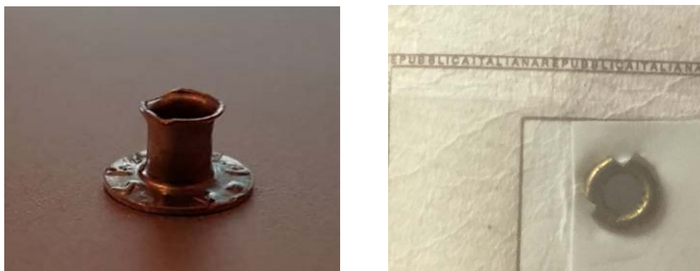
Figura 5-1: alcuni esempi dei difetti riscontrati su occhielli. Nel primo caso si può notare che non sia stato completamente lavorato dalla macchina (a sinistra) mentre nell'altro si presentano spaccature sul bordo deformato (a destra).
