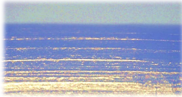
Figura 5-5: dettaglio del gambo dell'occhiello al microscopio a dove si notano le righe indotte dall'imbutitura
