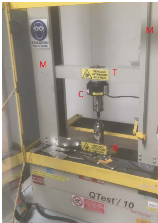
Figura 5-39 : macchina MTS QTest con cui sono stati fatti i test sugli occhiali
