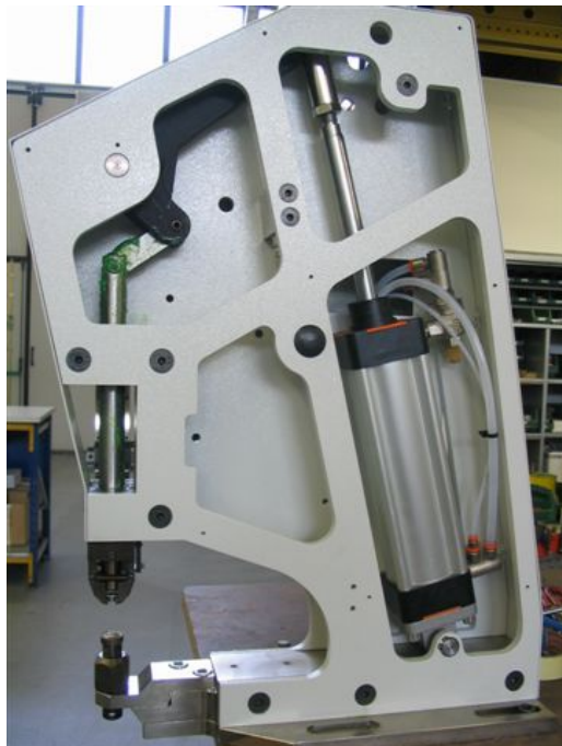
Figura 3-30: esempi di macchine occhiellatrici ad azionamento elettrico (a sinistra in alto) e pneumatico (in basso) [22].
