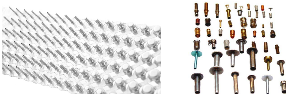
Figura 5-4: foglio metallico parzialmente stampato (a sinistra) e particolari ottenibili da imbutitura profonda (a destra)
