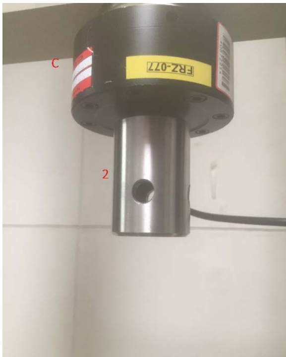
Figura 5-40: sistemi di attacco per l'attrezzatura al banco di prova. In particolare a sinistra si nota la cella di carico da 10kN fissata sulla traversa mobile
