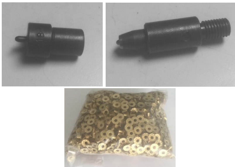
Figura 5-23 : (da sinistra) matrice, punzone e occhielli di Tipo-9 adoperati per le prove sperimentali
